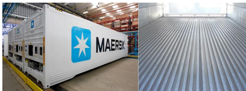
Figur 2. Reefer kontrolpanel og gulvbelægning med T-profiler.
