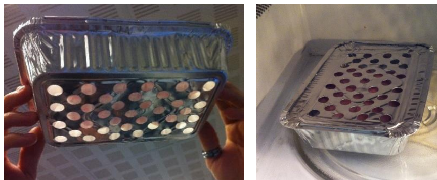
Figur 10. Afskærmning med 12 mm huller til mikrobølgeopvarmning af taglagt pålæg.
