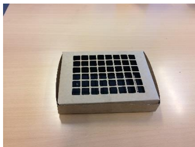
Figur 14. Afskærmning bestod af metalliseret papemballage med kvadratiske perforeringer.
