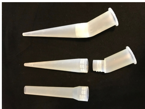
Figur 2. Knækdyser med gevind og knæk, 3D-printet på en SLA-printer
