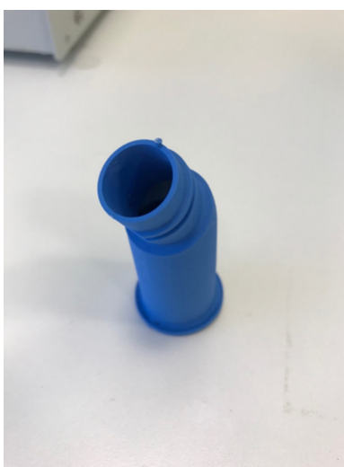
Figur 5. Den fyldte sprøjtestøbeform lægges i varmt vand, og det støbte emne frigøres. Her er det bunden af dysen, som har en vinkel med gevind.
