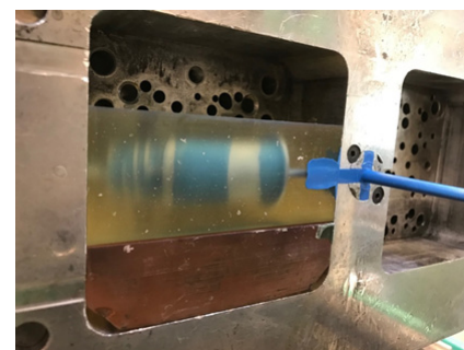
Figur 4. En 3D-printet form anvendes i en sprøjtestøbemaskine og fyldes med polyethylen.
