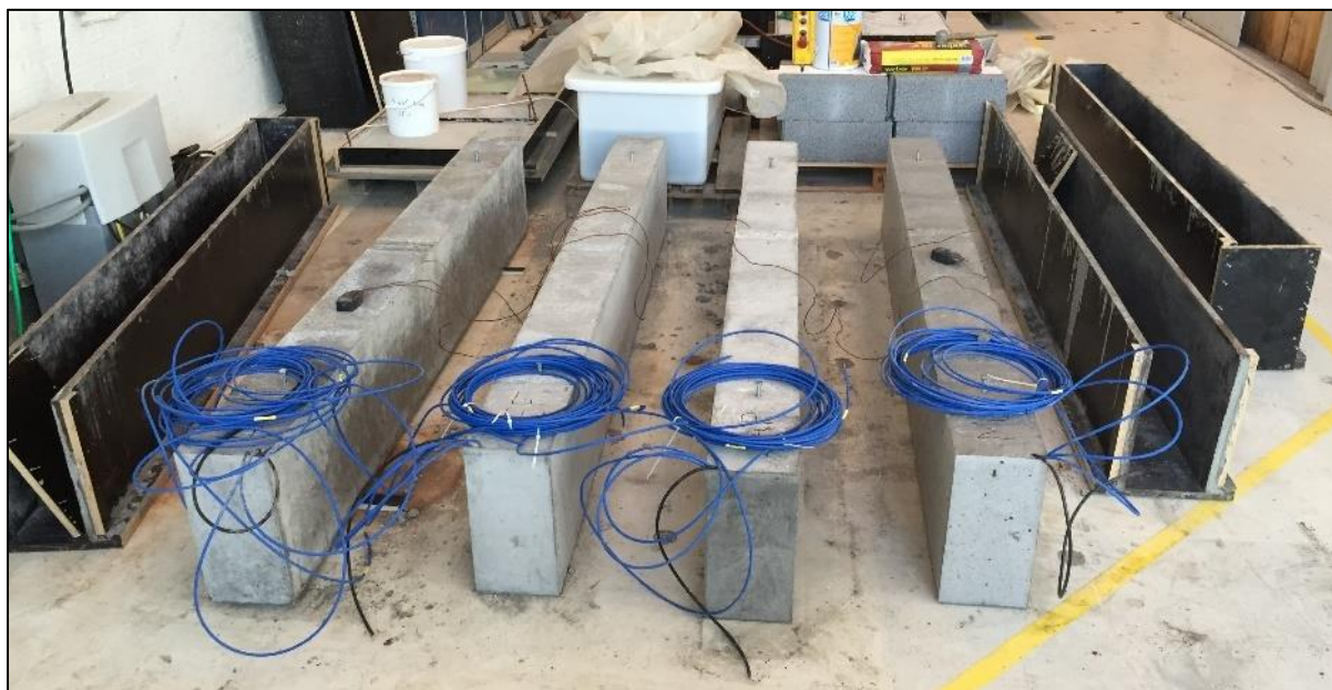
Fig. 1. Betonbjælker med indstøbte healing agents fremstillet til felteksponeringsforsøg i forbindelse med Healcon-projektet.
