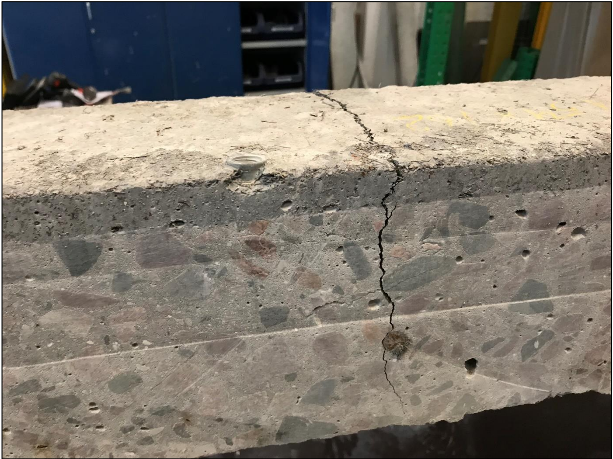
Fig. 12. Eksempel på revnedannelse i ét af de to testemner, hvor bøjningsforsøget blev udført med UHPFRC-laget i træksiden. Selv efter at emnet er revnet, kunne der optages en del last.
