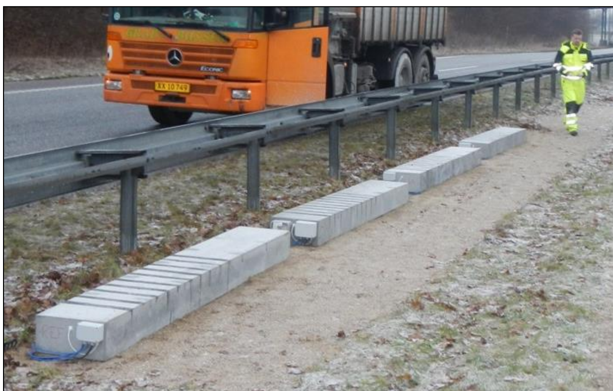
Fig. 3. Felteksponeringsplads ved Hveen Boulevard, Taastrup. På billedet ses fire revnede betonbjælker, hvoraf de tre er fremstillet med indstøbte healing agents. Alle bjælkerne er fremstillet med indstøbt armeringsjern samt et system til trådløs registrering af eventuel korrosionsaktivitet.
