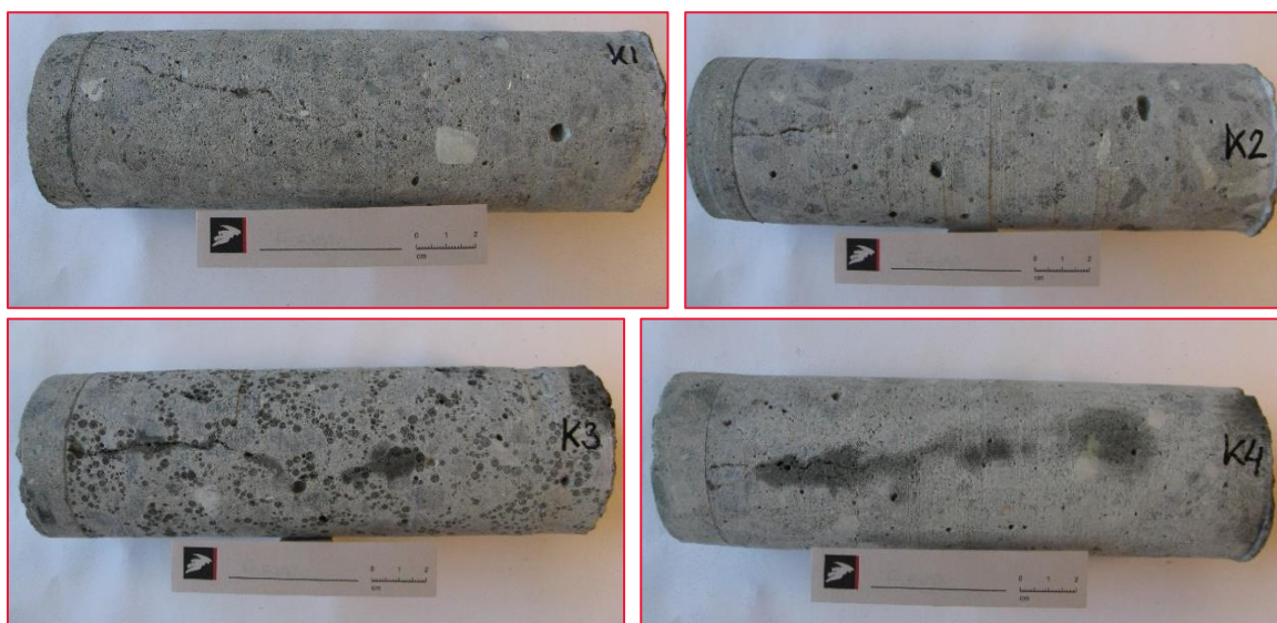
Fig. 4. Borekerner udtaget fra revnede betonbjælker fra felteksponeringspladsen ved Hveen Boulevard i Taastrup efter ca. 1 år og 3 måneders eksponering: (A) Referencebeton fremstillet uden healing agents, (B) beton med SAP-G, (C) beton med Liapor imprægneret med bakterier og (D) beton med MUC ++ .
