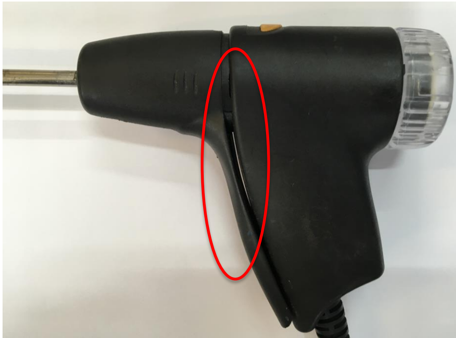
Røggassonde sluttede ikke tæt ved samling.
