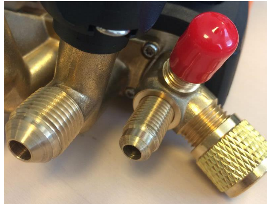
Åbne indgange, med blændprop parkeret på blændstuds
