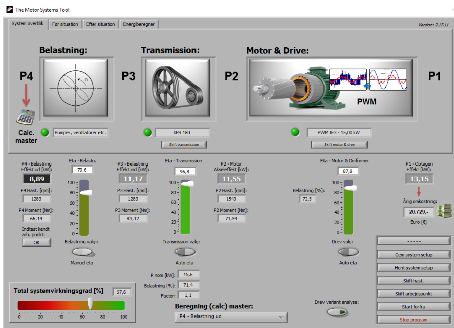
Figur 5.17. Output fra programmet efter udskiftning af remskiver
