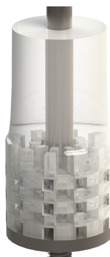
3D-tegning af silikoneindsats på titaniumskruer til knogler. Hullerne gør, at biologisk væv kan vokse ind i dem og sidde bedre fast.
