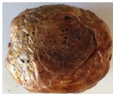
Figur 6. En 300g kartoffel efter 4 minutters tilberedning ved 1000W i mikrobølgeovn ved brug af en tæt omslutning med den tolags PET-baserede susceptør.
