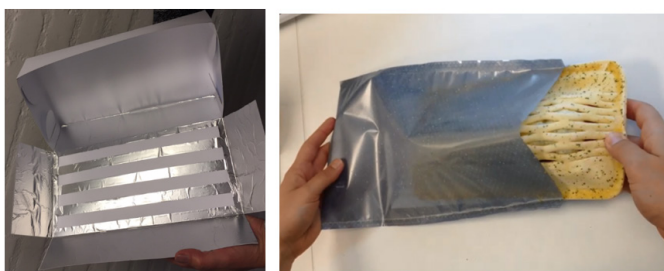
Figur 8. Emballage til mikrobølgeovnstillberedning af 600g frossen indbagt laks bestående af en papkasse med et aluminiumsmønster, der delvist transmitterede mikrobølgerne, og en pose lavet af tolags PET-baseret susceptormaterial.
