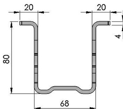
Stålprofilerne har både trækstyrken kendt fra de traditionelle betonfundamenter og fordelene ved det klassiske punktfundament i beton:
