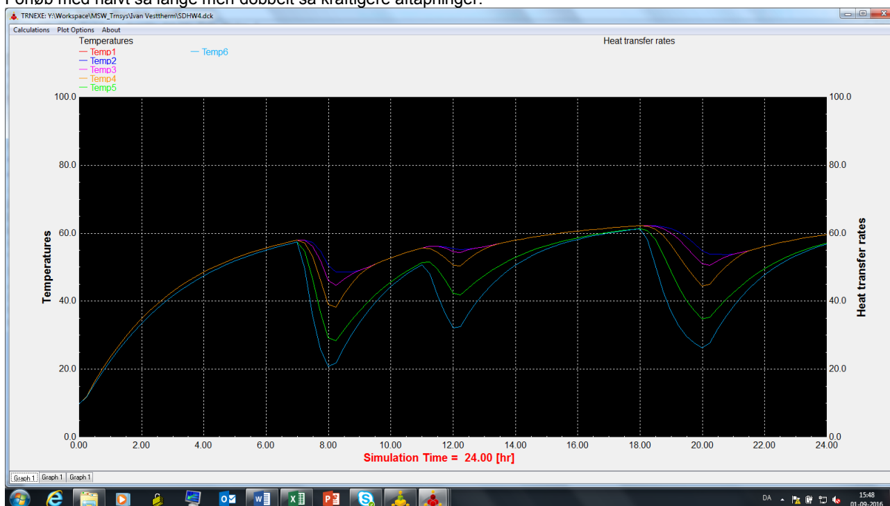
Figur 8 Dynamisk temperaturforløb med 80 cm veksler og tre tapninger.
