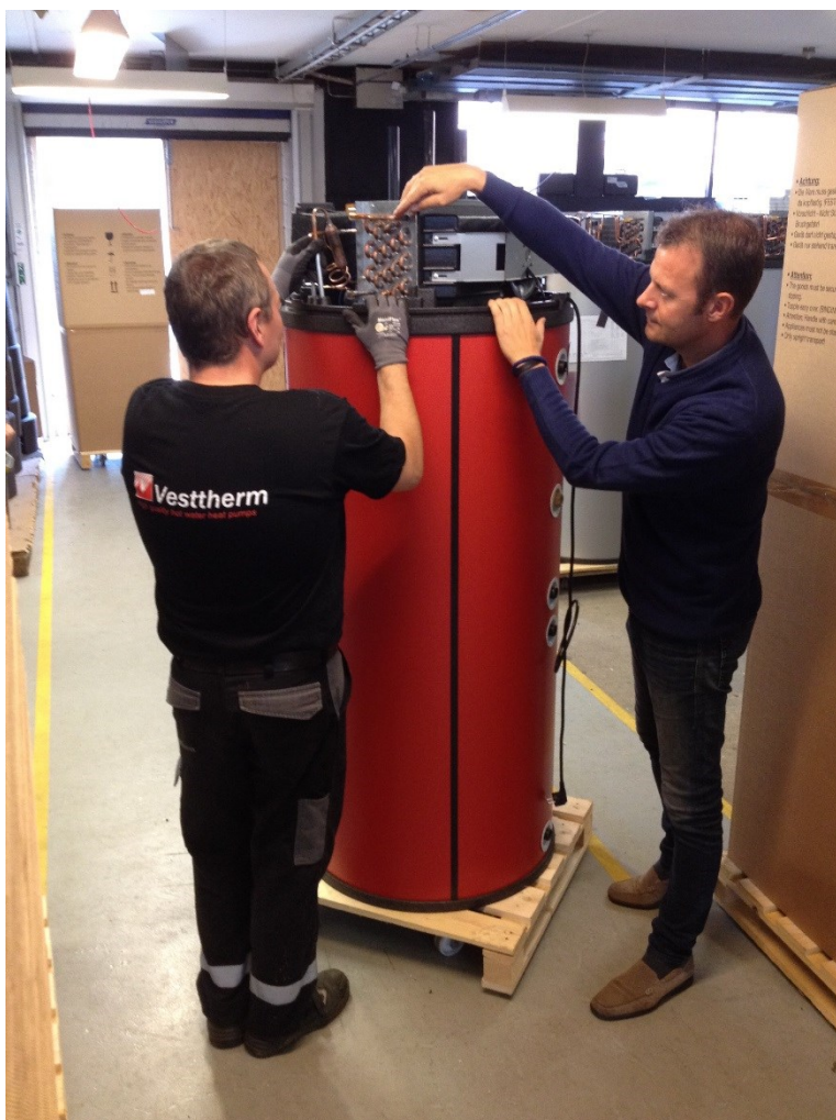
Foto: Fra produktionen hos Vesttherm i Esbjerg. På billedet vises nogle af komponenterne i brugsvandsvarmepumpen (fordamper + ventilator samt kompressor).
