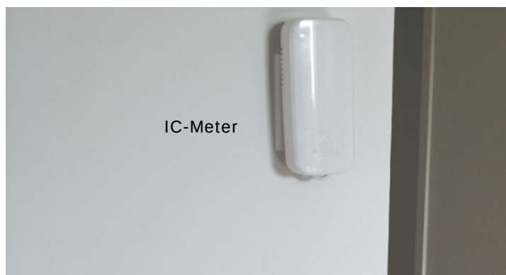
Figur 4.6 IC-Meter placeret i stuen i en af lejlighederne.
