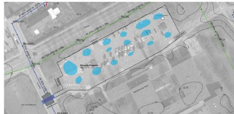
2_ ved store regn: pytter ved riste (måned)
