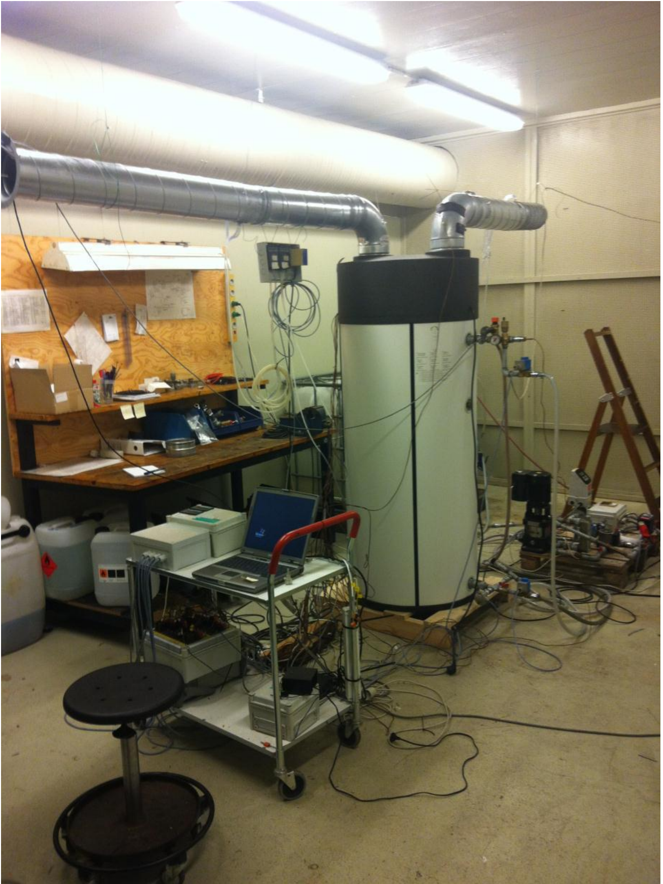
Foto af teststand for brugsvandsvarmepumper på Teknologisk Institut
