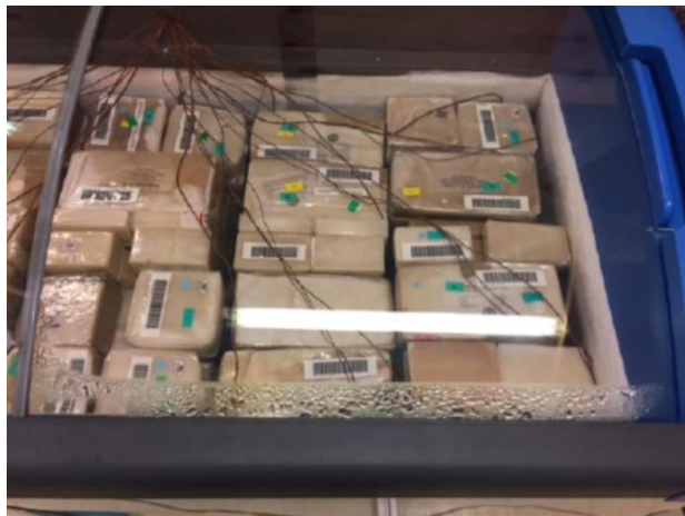
Foto 3: Her ses kondensdannelse på forsiden oven på glaslågen, når elvarmelegemet er slukket.
