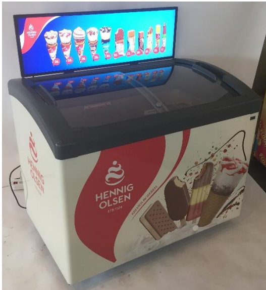
Foto af prototype af Fokus 131 kommercielt og under akkrediteret døråbningstest i klimakammer på Teknologisk Institut.
