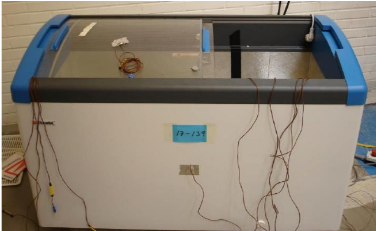
Foto 2: Referenceiscremfryser monteret med ekstra temperaturmålinger.
