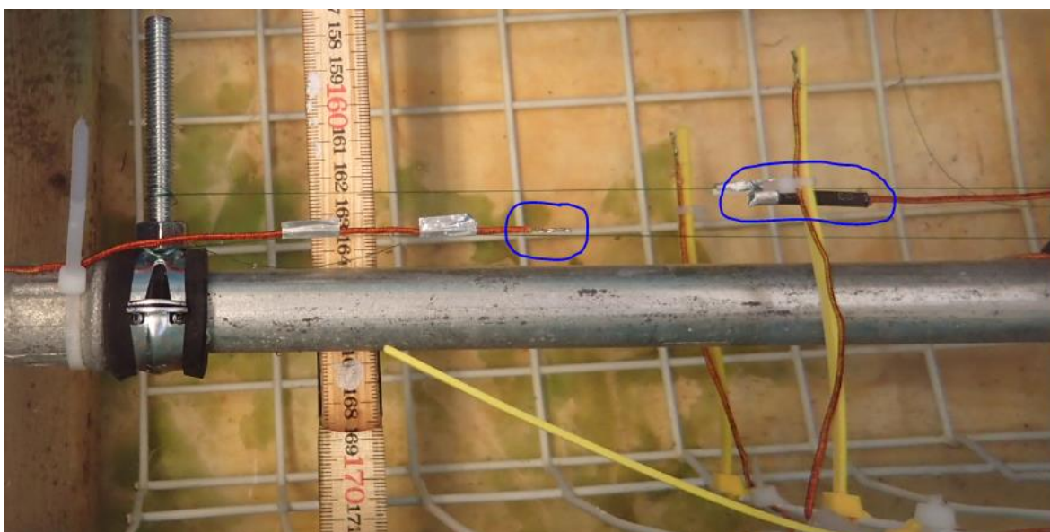
Figur 25: Billede af termoelementernes placering ved forsøg 10.
