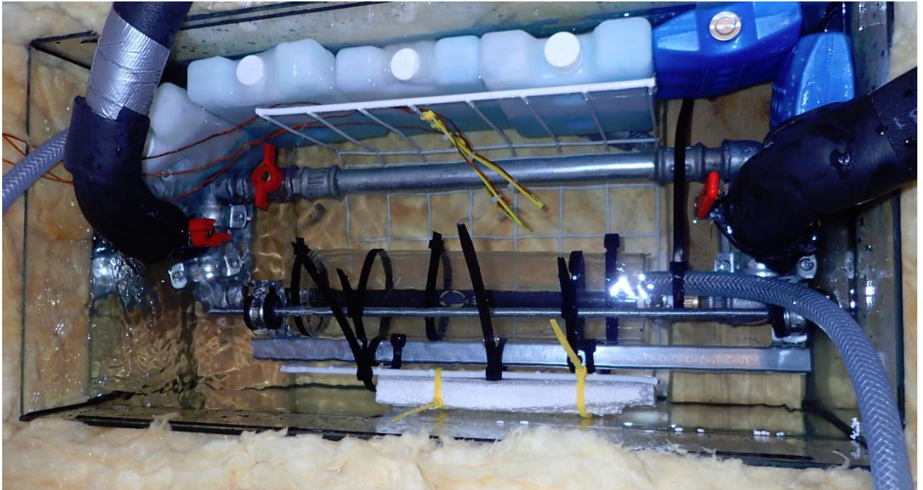
Figur 21: Billede af gennemsigtigt plastikrør monteret til at guide flow forbi testemnet for at skabe tvungen konvektion.
