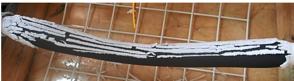
Figur 17: Frigørelse af rim ved testemne eksponeret for fugtig luft.
