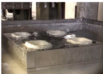
Figur 14. Pulfordeling – fire plastnet brugt til støbeformning.
