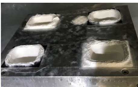
Figur 13. Ujævn pulpfordeling, der skyldes varierende åbenhed hos metal- og plastnettene.
