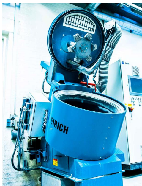
Figur 1: Blander anvendt til støbning af de fire betonserier.
