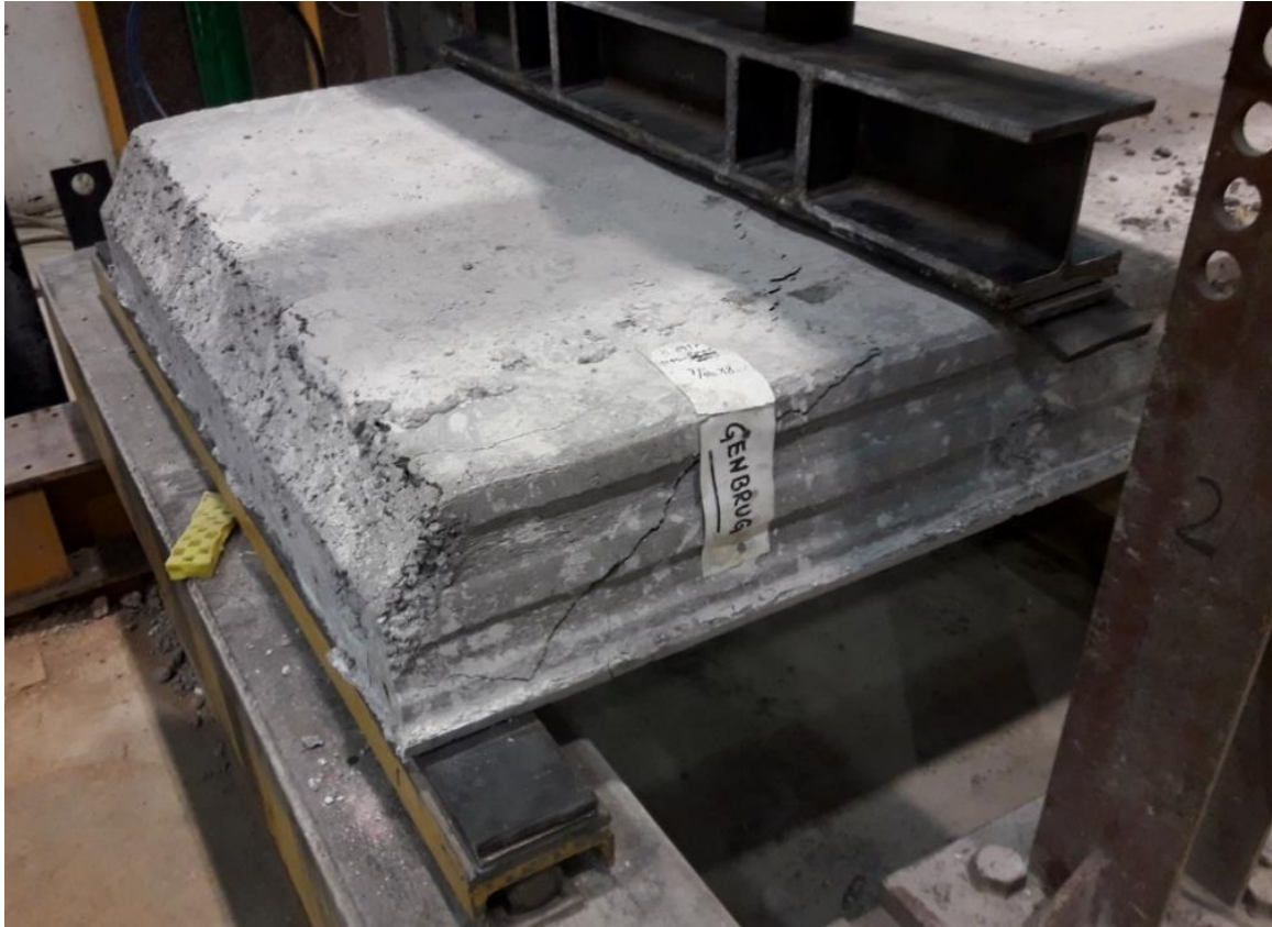
Figur 36: Forsøgsopstilling anvendt til måling af forskydningsbæreevne hos CRH Concrete.
