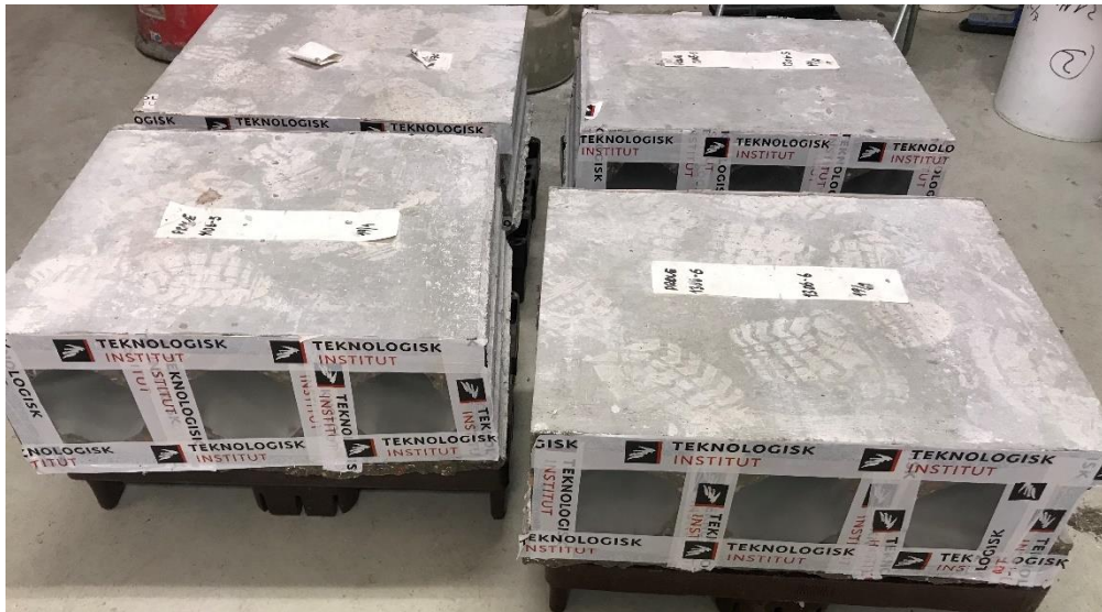
Figur 26: Udsåret huldæksemner til måling af fugtindhold over tid.
