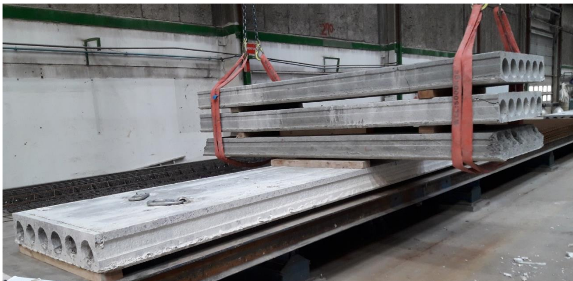
Figur 32: Forsøgsopstilling til fuldskala deformationsmåling med belastning.
