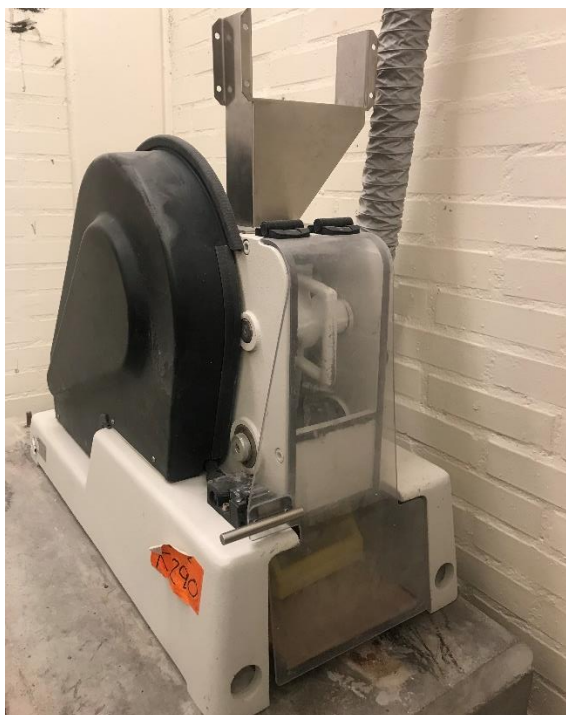
Figur 3: Kæbeknuser anvendt til knusning af de 4 betonserier.
