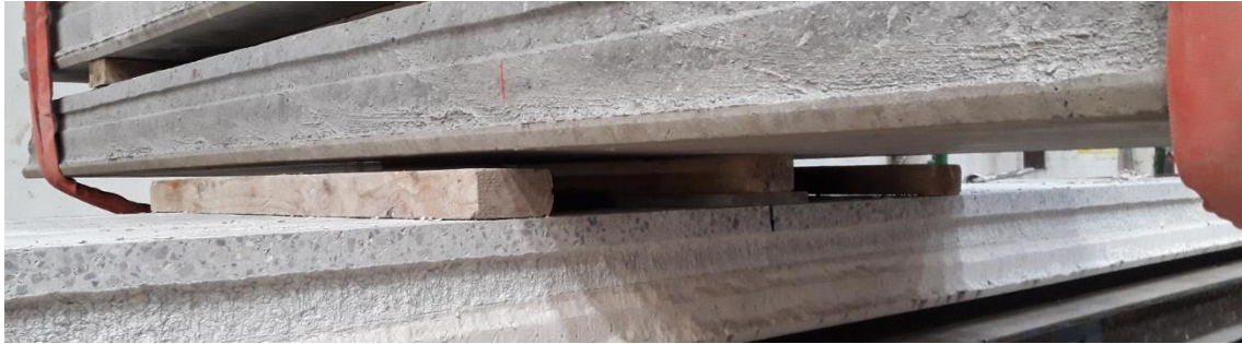
Figur 33: Forsøgsopstilling til fuldskala deformationsmåling, hvor det ses, at ballasten udelukkende ligger på den midterste trælægte.
