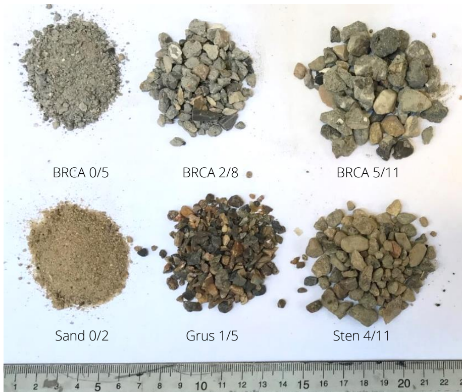
Figur 12: Genanvendte tilslag fra spildbeton fra belægningsproduktionen (øverst) og jomfruelige tilslagsmaterialer (nederst). RCA står for "recycled concrete aggregates".
