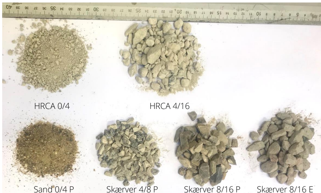
Figur 16: Genanvendte tilslag fra spildbeton fra huldæksproduktion (øverst) og jomfruelige tilslagsmaterialer (nederst). RCA står for "recycled concrete aggregates".
