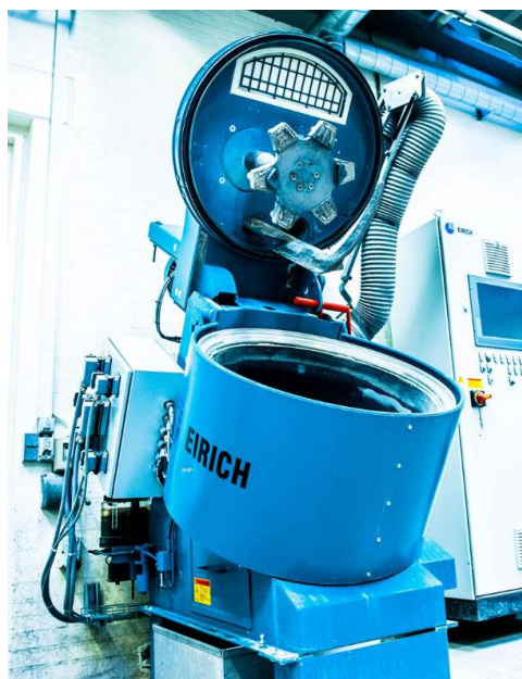
Figur 38: Blander anvendt til blanding af fabriksbeton.
