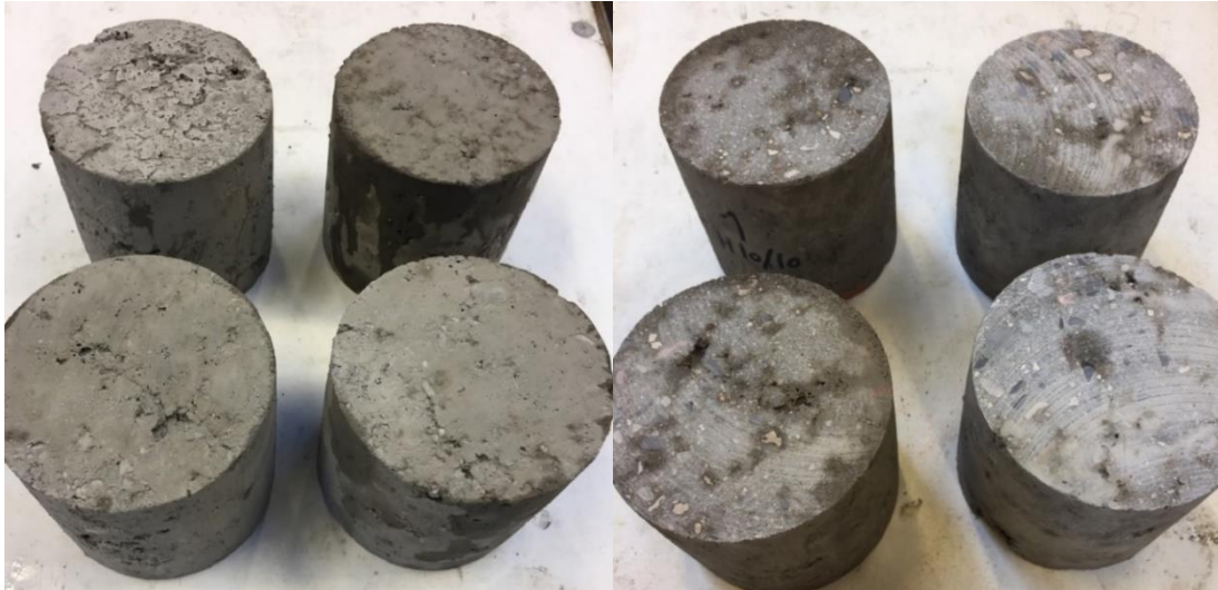
Figur 19: Eksempel på prøveemner støbt med huldæksbeton til måling af styrkeudviklingen før slibning (til venstre) og efter slibning (til højre).
