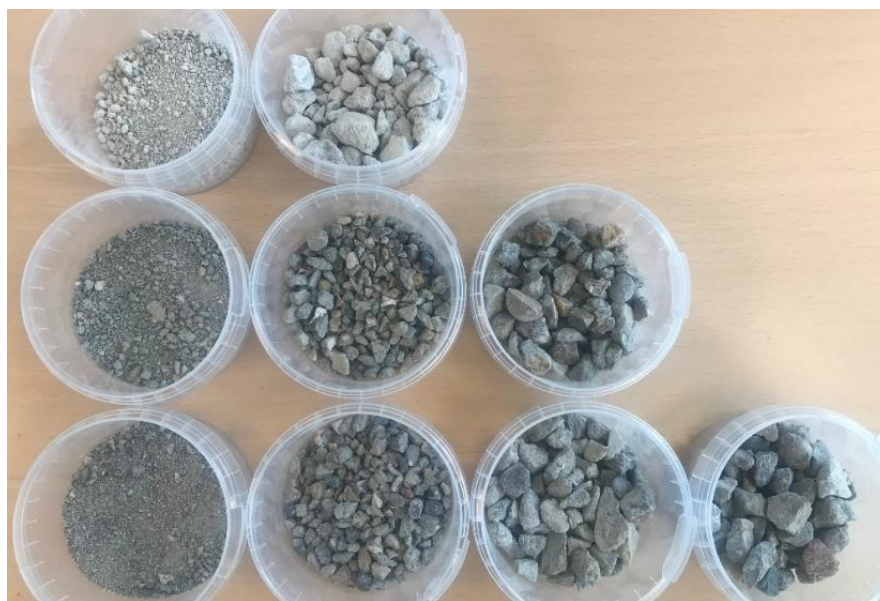
Figur 6: Genanvendte tilslag fra spildbeton. Øverst = HRCA 0/4 og 4/16 (H=huldæk, RCA = recycled concrete aggregates), midterst = BRCA 0/5, 2/8, 5/11 (B=belægningsprodukter), nederst = FRCA 0/5, 2/8, 5/11, 8/16 (F=Fabriksbeton).
