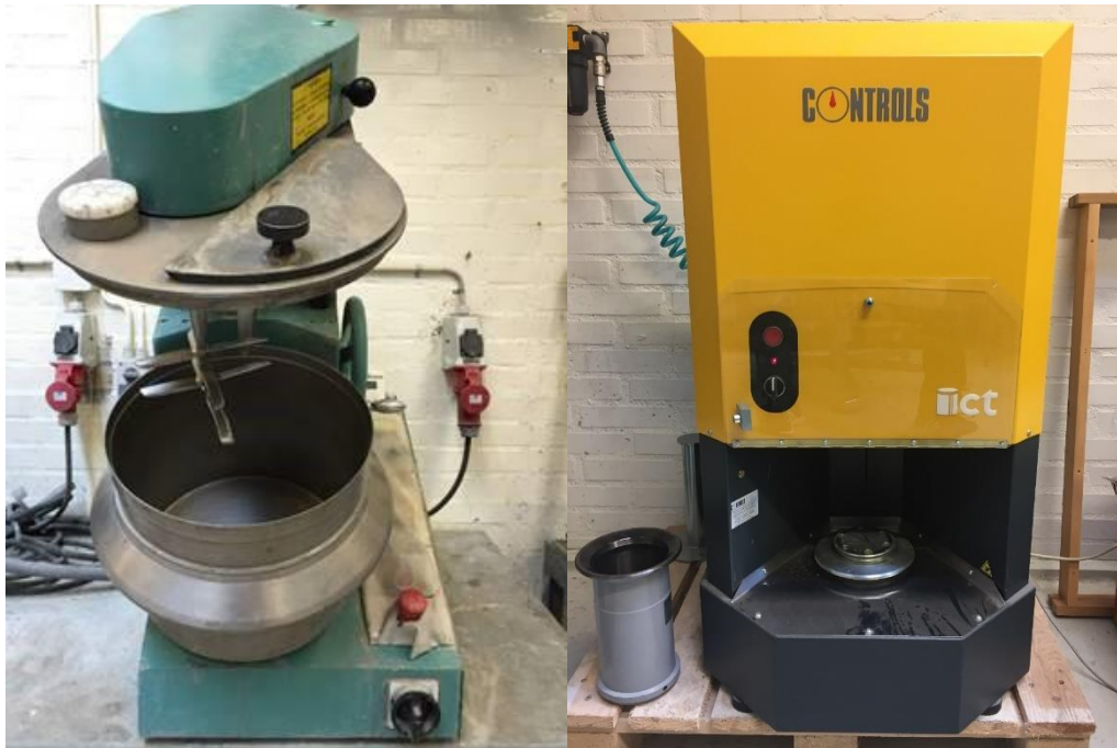
Figur 17: Anvendt blander (til venstre) og ICT-tester anvendt til støbning af prøveemner (til højre).
