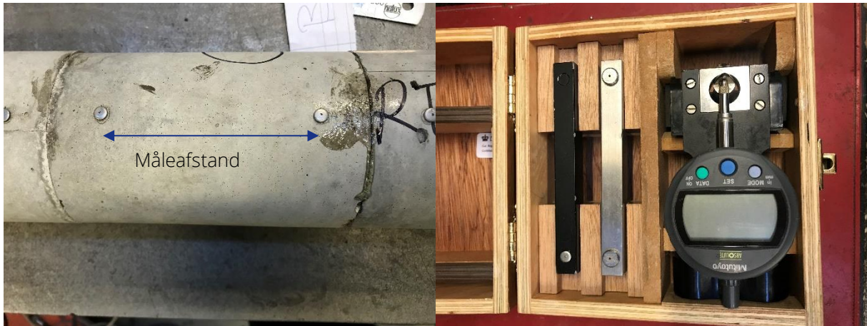
Figur 29: Pålimet demec punkter (til venstre) og demec måler (til højre) anvendt til måling af deformation over tid som følge af krybning.
