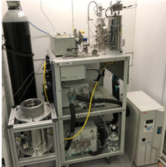
Figur 7. Anlæg til ekstrahering eller imprægnering med superkritisk CO_2 hos Plast og Emballage.
