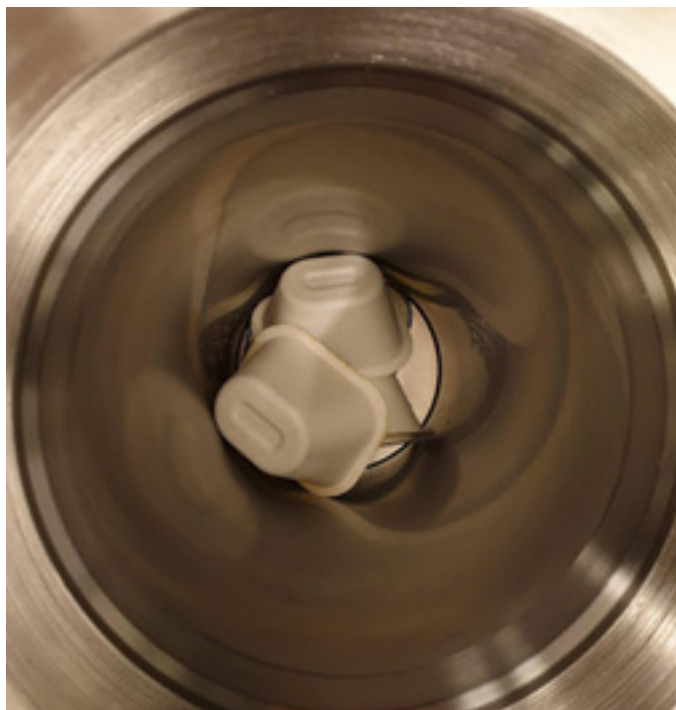
Figur 8. Plasma-coatede papirbakker, der er placeret i scCO_2 -tanken for at blive imprægneret, hvor timianolien også er til stede.
