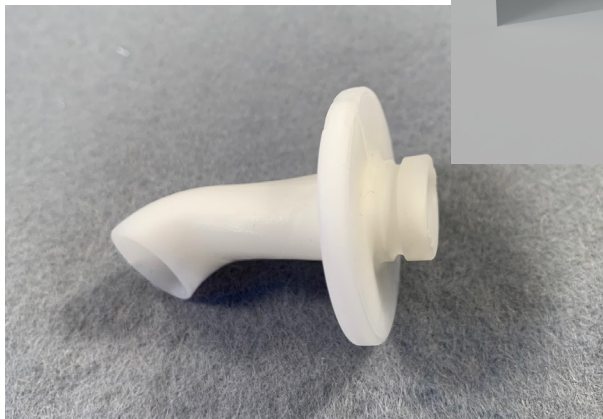
Kateter støbt i polypropylen via 3D-printede sprøjtestøbeform.
