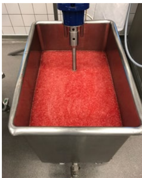
Ekstraktion af protein fra griselunger under omrøring i en basisk opløsning.
