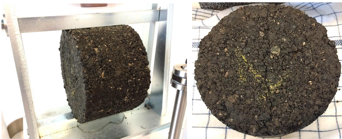
Fig. 7.12 (tv): Spaltetrækstyrkeopstilling. Fig. 7.13 (th): Brudt kerne med næsten lineært spalte-brud fra top til bund – men stadigvæk sammenhængende!.
