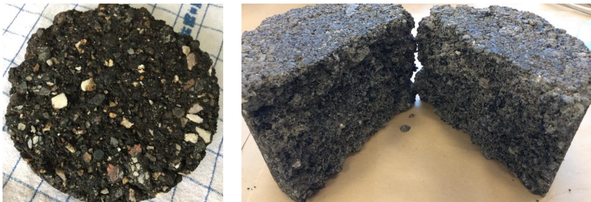
Fig. 7.10 (tv): Overskåret flade med tydeligt gennemskårne sten trods brug af asfaltsav med vand. Fig 7.11 (th): Efter afsluttet spaltetrækforsøg blev én af kernerne brækket op for at vurdere brudfladen (krævede dog en del energi og kræfter, samt hjælp af en skruetrækker!). Der ses adskillige brudte sten i fladen, hvilket indikerer høj styrke og kohæsion i materialet.
