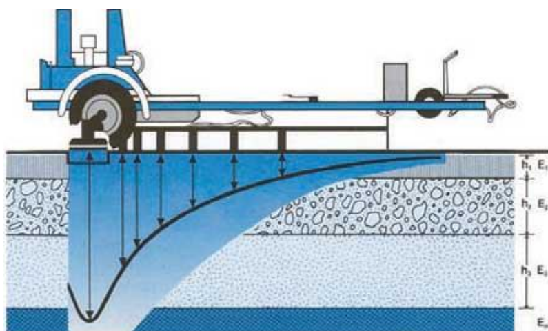
Fig. 7.18: Princip for bæreevнемåling med faldlod, hvor en række geofoner måler nedsynkningsbassinet respons fra faldloddets nedslag.
