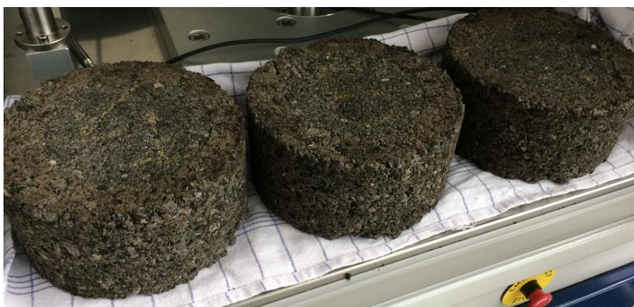
Fig. 6-3: Indstampede BSM-KMA kerner. Faste og stabile, men dog lidt løsere og mere grå overflader end for varmblandet asfalt.
