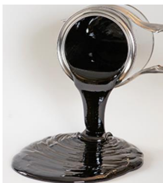
Fig. 4.2: Til BSM skumbitumen anvendes kun standard vejbitumen.
