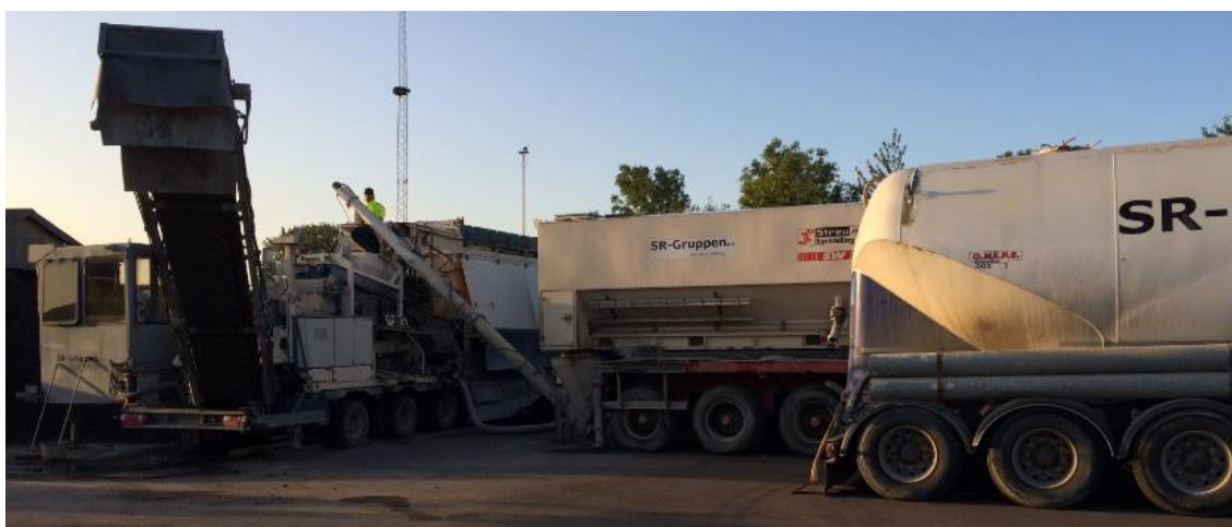
Fig. 7.5: Det anvendte BSM-KMA anlæg i produktion
