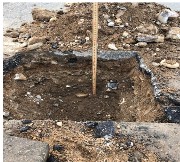
Fig. 7.4 (nedenfor): Ved prøveopgravning viste vejbelægningen sig at bestå af ca. 7 cm asfalt ovenpå ca. 25 cm ubundet grus.
