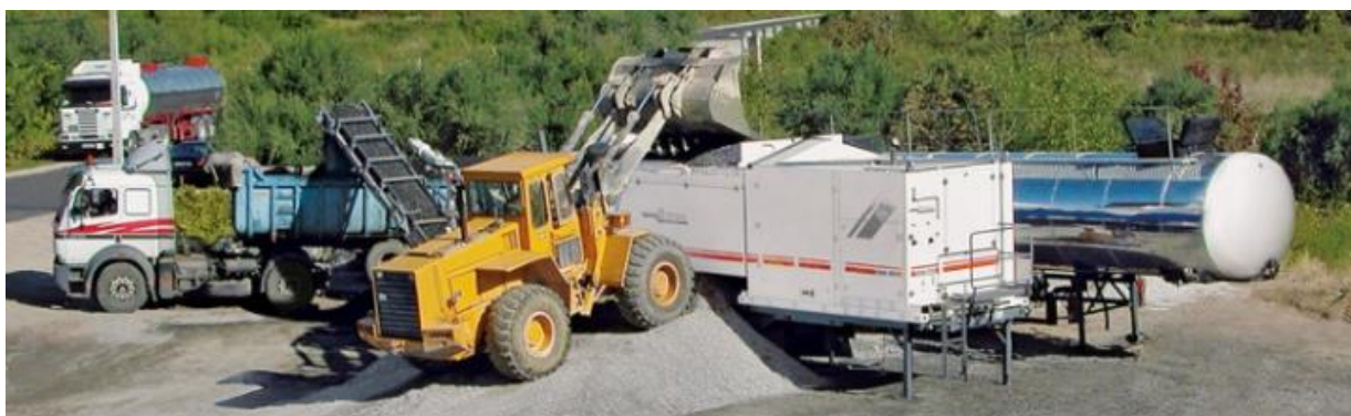
Fig 2.2: Eksempel på mobilt KMA-anlæg til fremstilling af BSM-KMA. (Kilde: Wirtgen).
