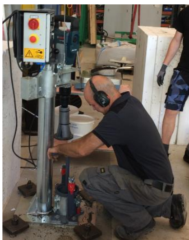
Fig. 6-2 A og B: Indstampning med vibrationshammer og legemer i Ø15 cm splitforme
