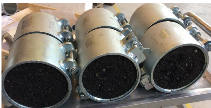
Fig. 6-2 A og B: Indstampning med vibrationshammer og legemer i Ø15 cm splitforme
