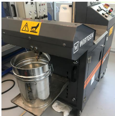
Fig. 5.1 a og b: Skumningsenhedens dyse (t.v.) sender varm skumbitumen ned i testspanden. Den røde målepind (t.h.) benyttes til bedømmelse af ekspansionsraten og halveringstiden for skummet.
