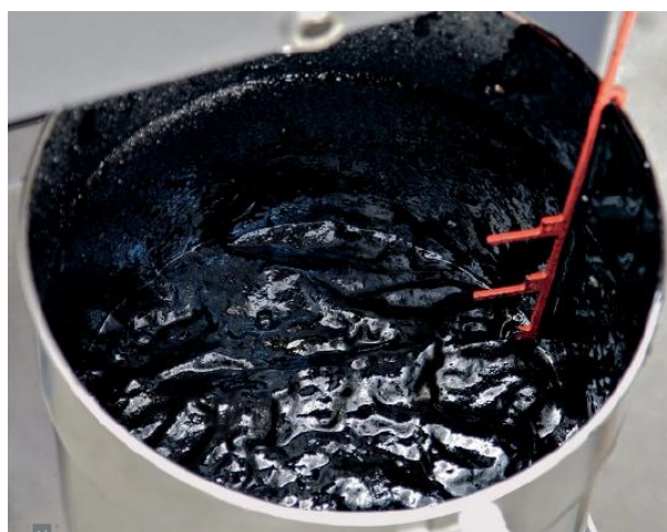
Fig. 5.1 a og b: Skumningsenhedens dyse (t.v.) sender varm skumbitumen ned i testspanden. Den røde målepind (t.h.) benyttes til bedømmelse af ekspansionsraten og halveringstiden for skummet.
