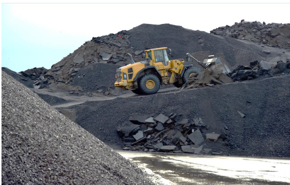
Foto 2.1: Genbrugsasfalt: Et glimrende råstofmateriale til vejbygning, som generelt er til rådighed, trods øget anvendelse i varmblandet asfalt (Kilde: MUDP-rapport "Cirkulær Asfaltproduktion i Danmark").
