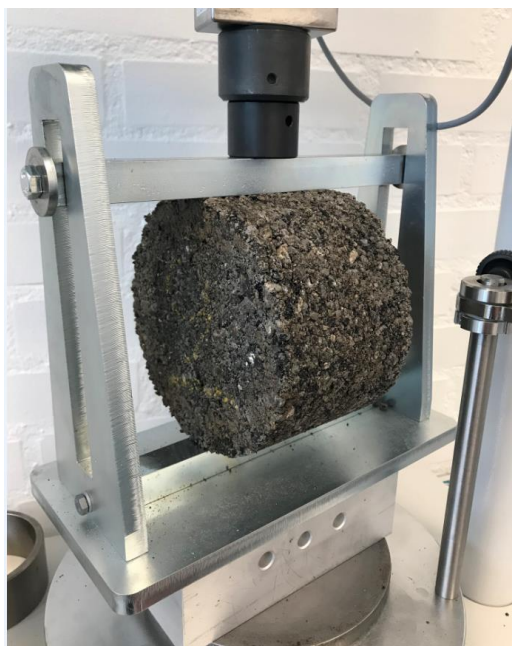
Fig. 6.4: Spaltetrækstyrketest på Ø150 mm BSM-prøvelegeme.
