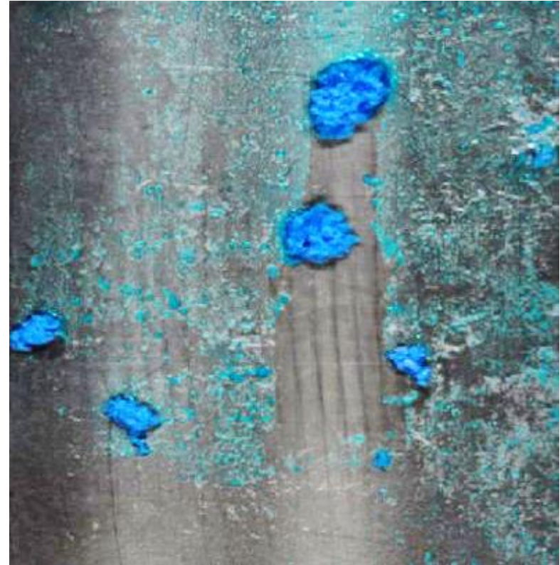
Stålplade med biofilm og kødrester
