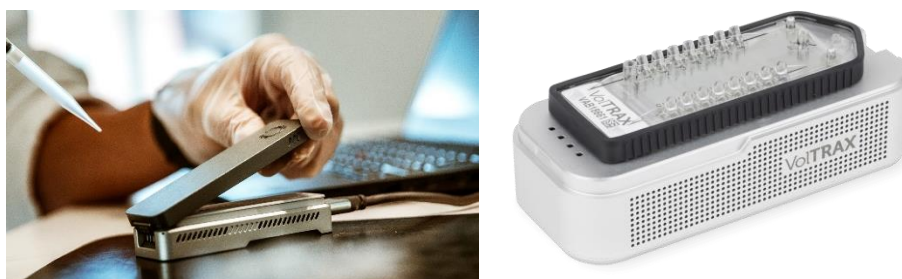
Figur 6. Håndholdt 16S rRNA gensekventering. Oxford Nanopore MinION sekventeringsmaskine (tv). Oxford Nanopore Voltrax instrument til forberedelse af sekventeringsmateriale (PCR m.m.) (th).
