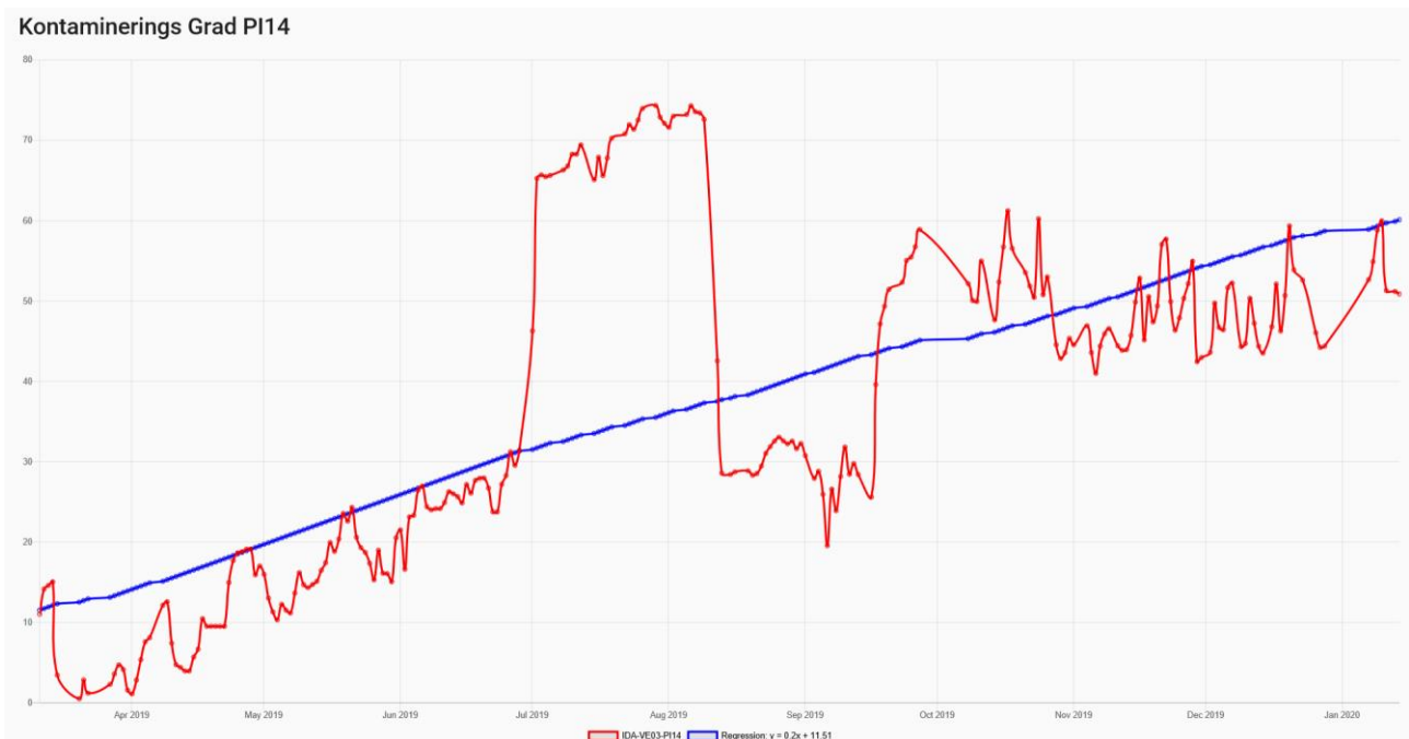
Figur 8.1.7 Kurve over kontamineringsgraden for indblæsningsfiltret i VE03 i IDA Huset.
