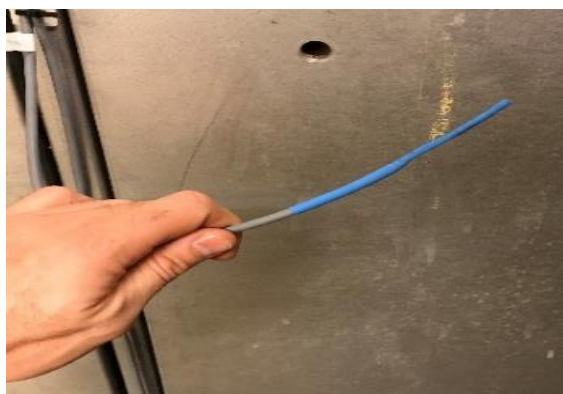
Figur 7.1.13 PT100 sensor loddet på kabel og afdækket med krympeflex.
