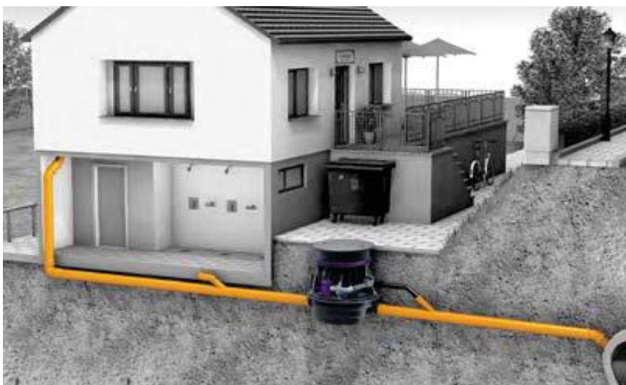
Figur 8.11. Et by-pass anlæg ved et enfamiliehus.
