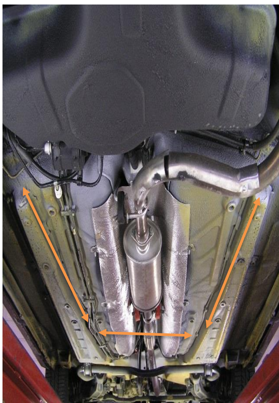
Behandling af tværvanger vanger og traverser samt hulrum i bundsektionen.
