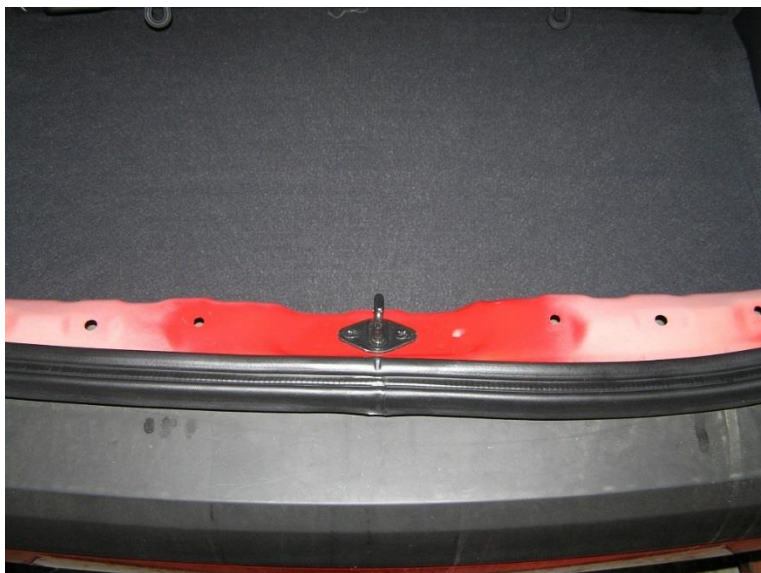
Behandling af hulrum i bagpanel i bagagerum.
