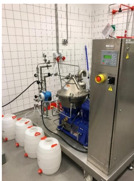
Centrifugering af lungeekstrakt med en Alfa Laval Clara 20 centrifuge
