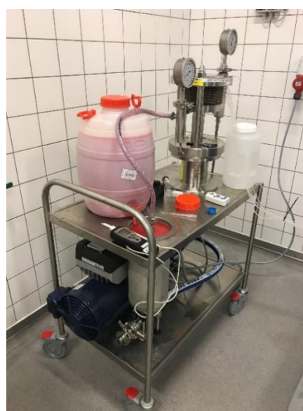
Membranfiltrering af supernatant (opløselig fraktion) med en Alfa Laval TestUnit M20.
