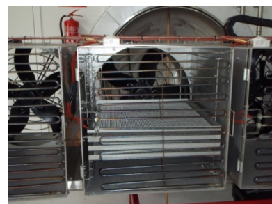
Figur 2c: Billede af en tørresektion med enkelte bakker monteret på hylderne, samt varmelegemet og ventilatoren.
