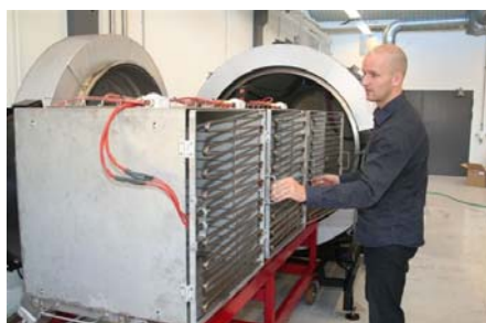
Figur 2a: Anlægget har plads til 42 produktbakker fordelt på 3 ens sektioner med hver sin ventilator og varmelegeme. Tørresektionerne er vist på en vogn uden for tørrekammeret.
