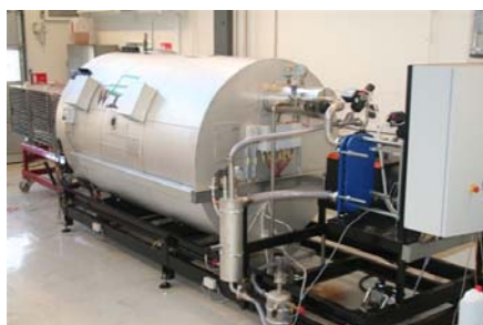
Figur 2b: Billedet viser hele laboratorieanlægget. Selve trykkammeret hviler på 6 vejeceller, som muliggør udarbejdelse af tørrekurver for forsøgsprodukterne.
