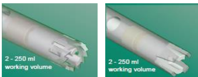
Figur 6. To homogeniseringsknive er anvendt under optimeringen af homogeniseringen. Kniven til venstre har vist sig at være mest effektiv.
