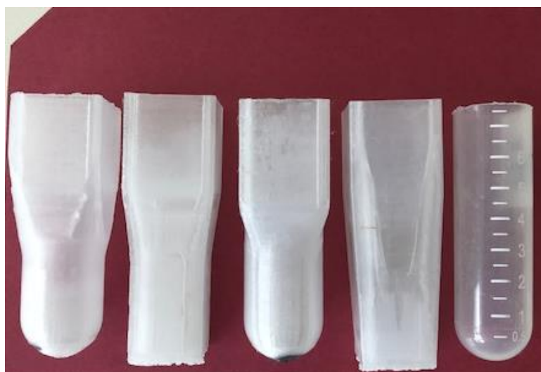
Figur 5. Der er arbejdet med forskellige brønddesign til 24 brønds DeepWell-plader. Disse er fremstillet vha. 3D-printning. Kuvetten længst til højre svarer til formatet på de reagensglas, der anvendes i laboratoriet.
