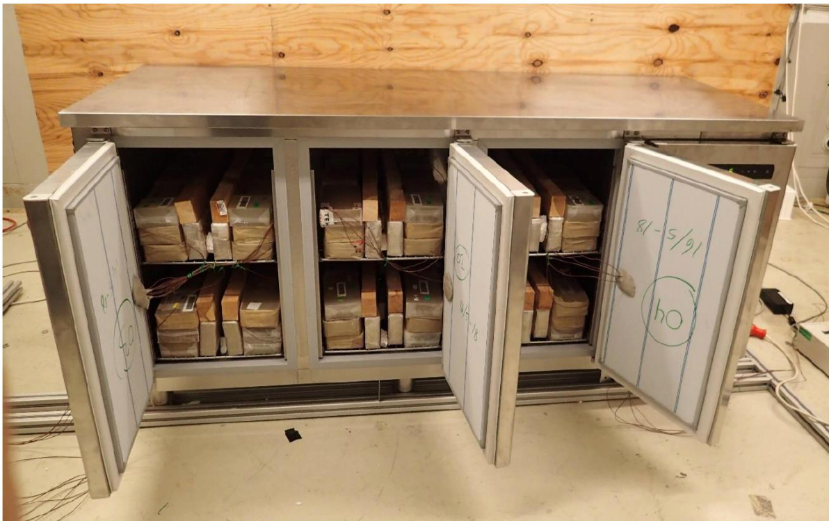
Figur 11.4: Foto af prototype med dørene åbne. Man kan se testpakker og målepakker.
