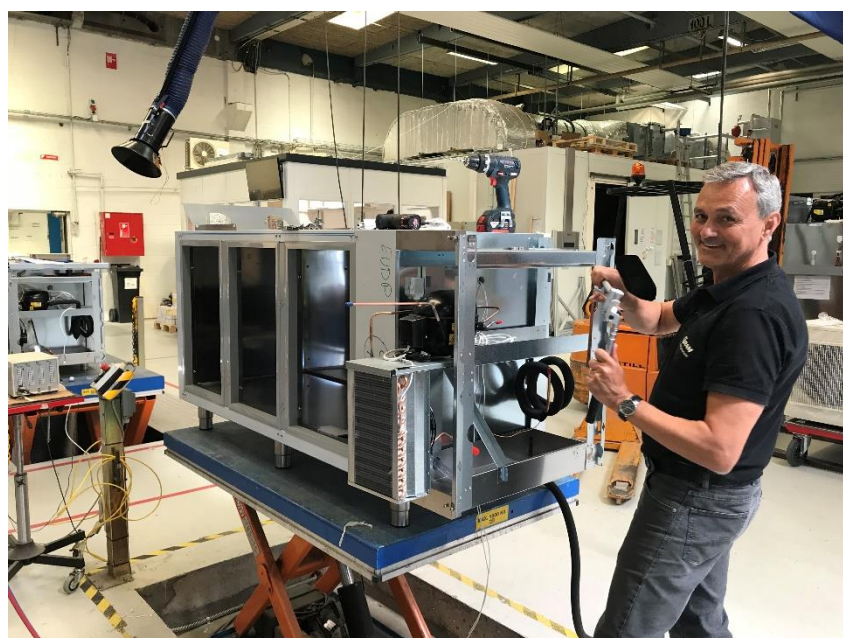
Figur 11.2: Bygning af køleborde til fieldtest.
