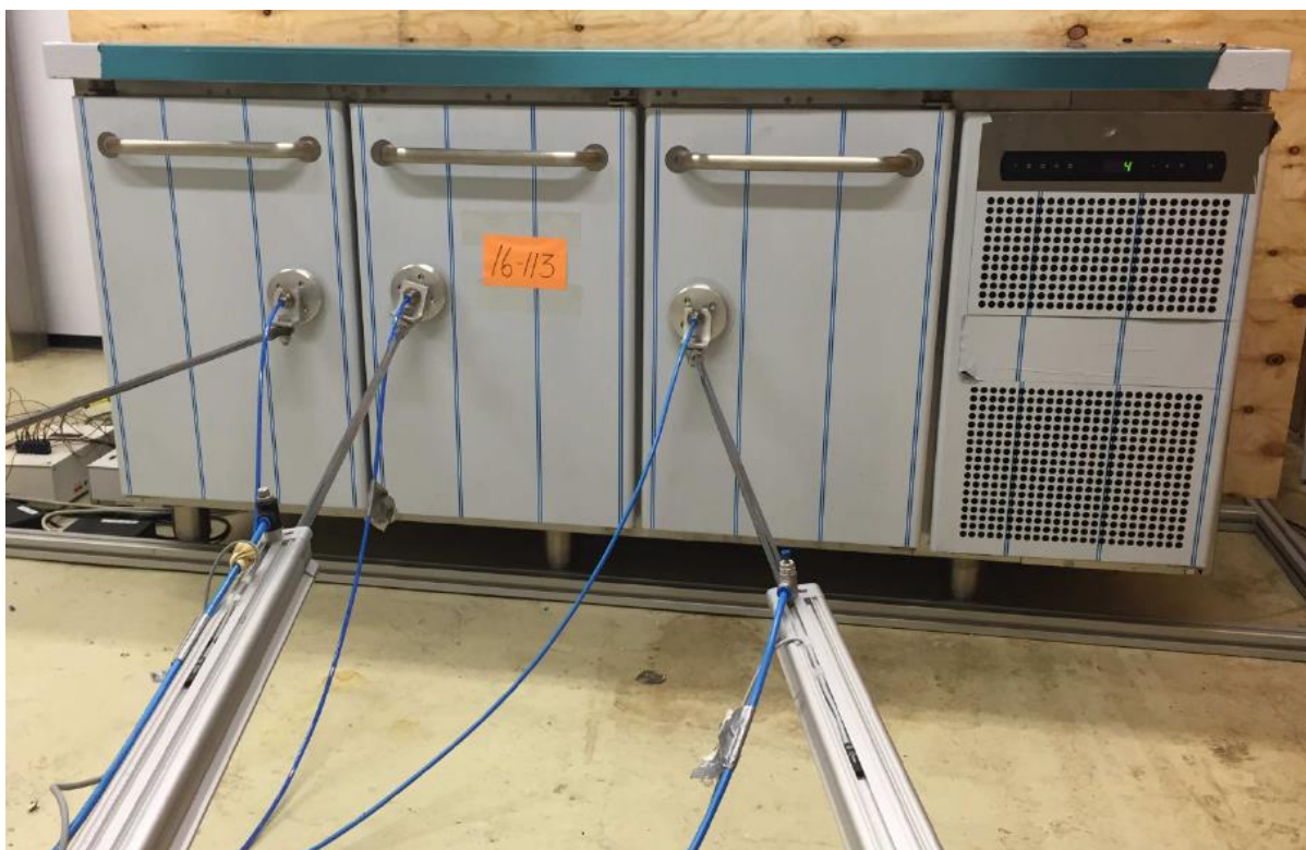
Figur 8.1: Test af det eksisterende kølebord med døråbningsrobotter i klimakammer på Teknologisk Institut efter EN16825.
