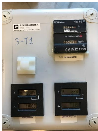
Figur 12.7: Målekasse, Energi, kompressor drift og døråbninger.
