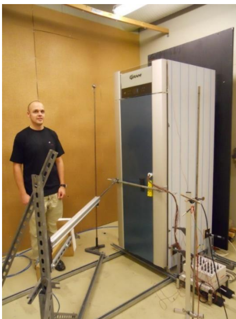
Figur 7.1: Et af Gram Commercial's nye storkøkkenkøleskabe under test i klimakammer på Teknologisk Institut. Under den akkrediterede test åbnes døren 72 gange i døgnet med en robot.
