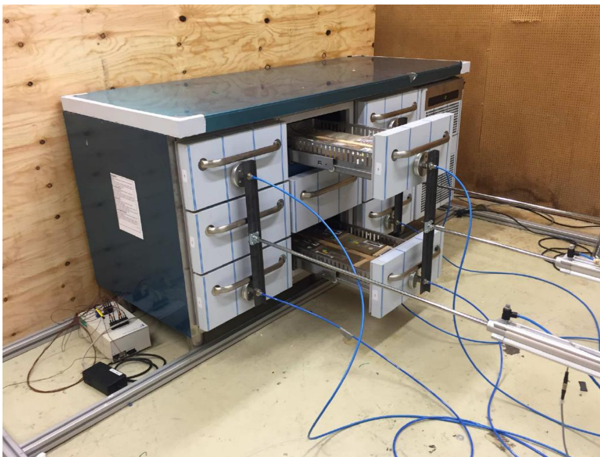
Figur 8.2: Test af kølebord med ni skuffer i klimakammer på Teknologisk Institut. Testen foretages efter EN16825. Under testen åbnes øverste og nederste skuffe simultant i sekvenser mellem de tre sektioner i kølebordet.
