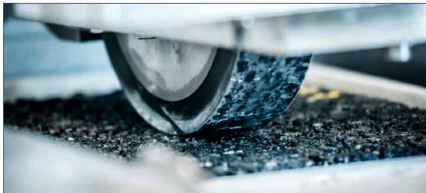
Fig. 6.6.1: Sporkøringsforsøget udføres med fastgummihjul og 10.000 dobbeltpassager ved 45°C, som antages at være den højeste temperatur, som et asfaltbærelag under danske klimaforhold udsættes for. Belastningstrykket svarer omtrentligt til en lastbils.
