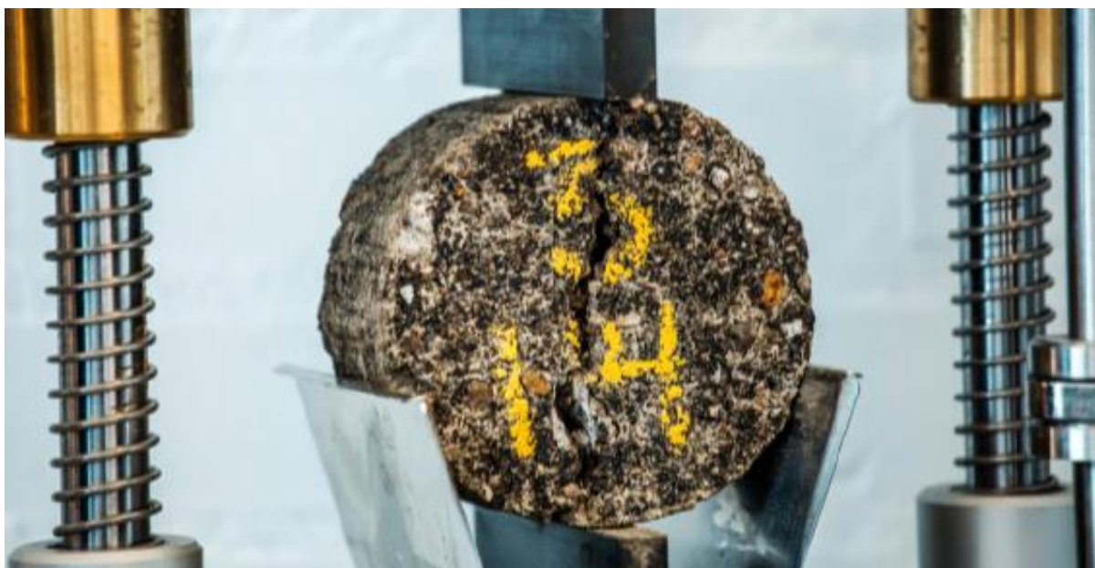
Fig. 6.4.1: Spaltetrækstyrkebestemmelse af Marshall-indstampet prøvelegeme.
