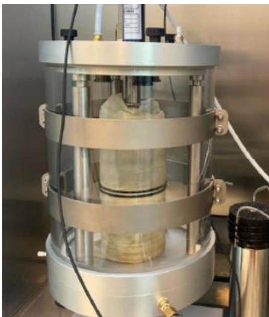
Fig. 6.7.1: Triaxial-test opstilling. Prøvelegemet er omsluttet af en tæt gummimembran. Via trykcellen påføres en konstant sidestøtte, der simulerer belægnings reelle sidestøtte ude på vejen. Via trykcylinderen og den vandret liggende belastningsskive (skjult af membranen) påføres lodret pulserende belastning. Deformationen registreres løbende op til 10.000 belastningscykler er gennemført.
