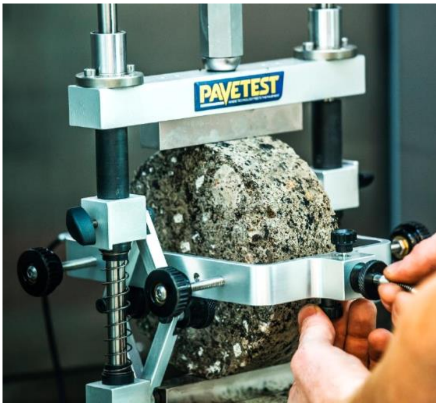
Fig. 6.5.1: Opstilling til stivhedsmodul-bestemmelse med hydraulisk DTS-30 testudstyr fra Pavetest
