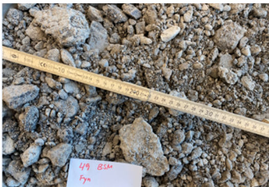
Foto af udtaget BSM-materiale i løs tilstand før indbygning.
