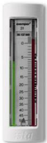
Figur 6.4. Fordampningsmåler. Der fordamper væske hele tiden også om sommeren. Derfor er røret overfyldt en smule. Det røde rør måler det aktuelle år, det grønne er fra året før til sammenligning og derfor proppet af.
