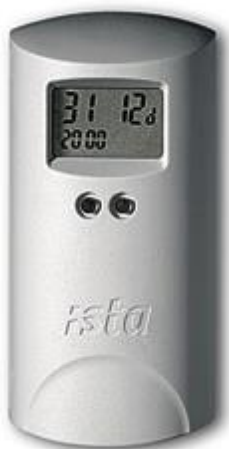
Figur 6.5. Elektronisk måler med to følere, en i forpladen og en i termisk kontakt med radiatoren. Krav til målerinstallation er angivet i [2]. Krav til egenskaber, montering og skalering er angivet i [3] og [4]. Der er ikke længere krav om typegodkendelse, men målerne skal overholde EN 834 og derudover bestemmelserne i [3] og [4].
