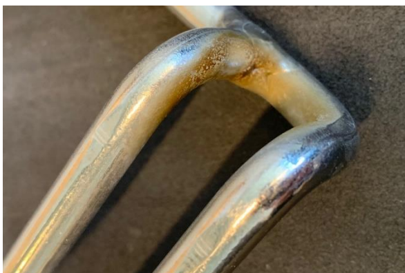
Figur 4. Nedslidt kontaktpunkt på bøjlen.
