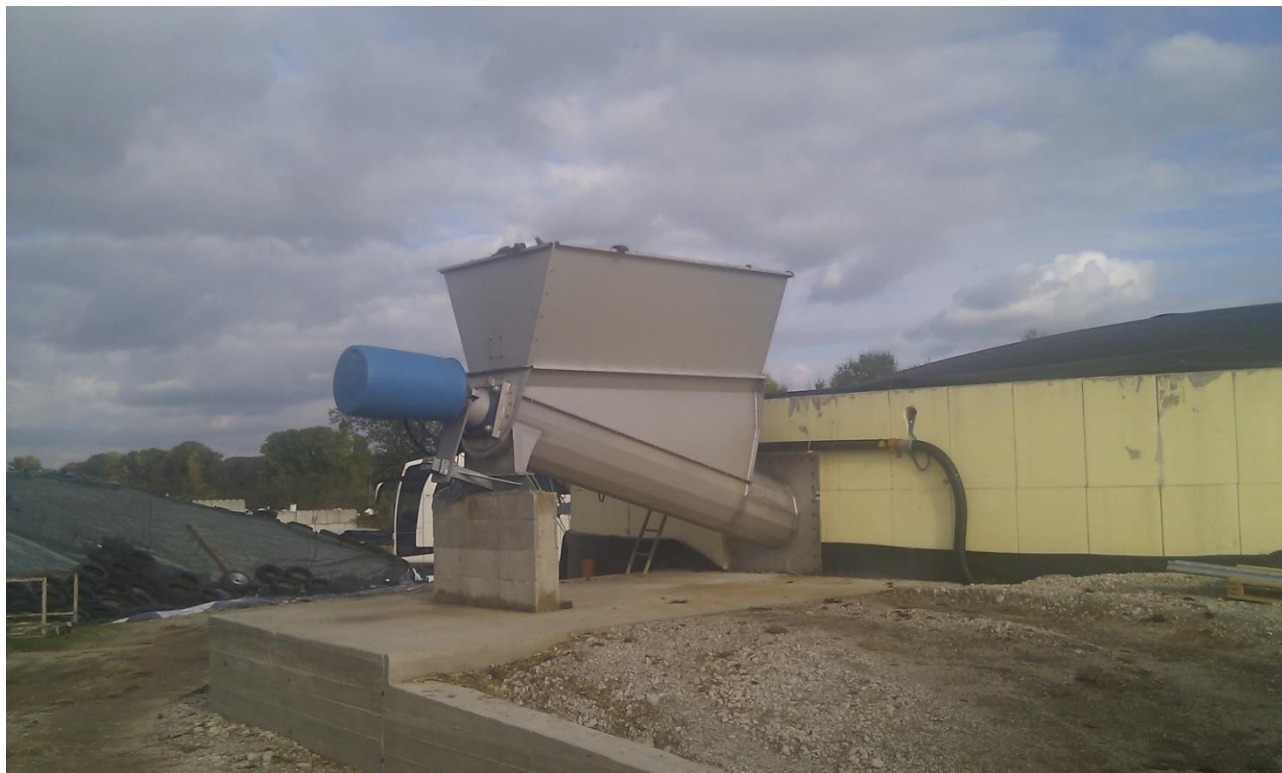
Figur 5. Biomassen snegles ind via en tragt. Gårdanlæg i Tyskland
