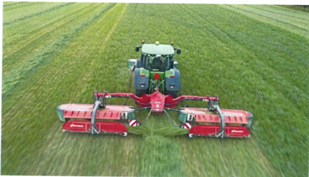
Figur 2: Kverneland butterflyskårlægger med bånd set bagfra.
