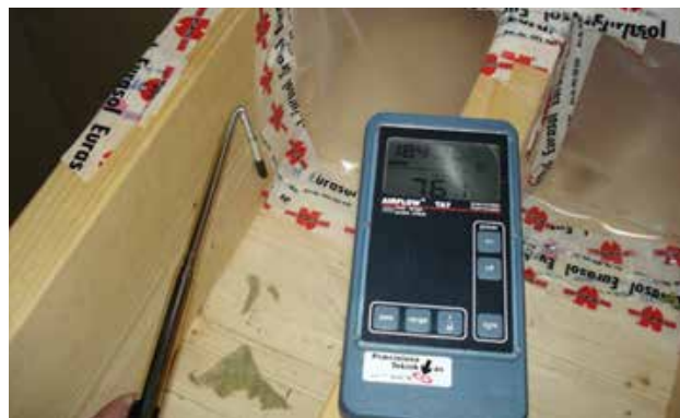
Figur 5.6 – Illustration af varmetrådsanemometer.
