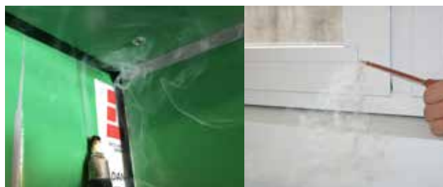
Figur 5.7 – Røgpenne til visualisering af mindre utætheder.
