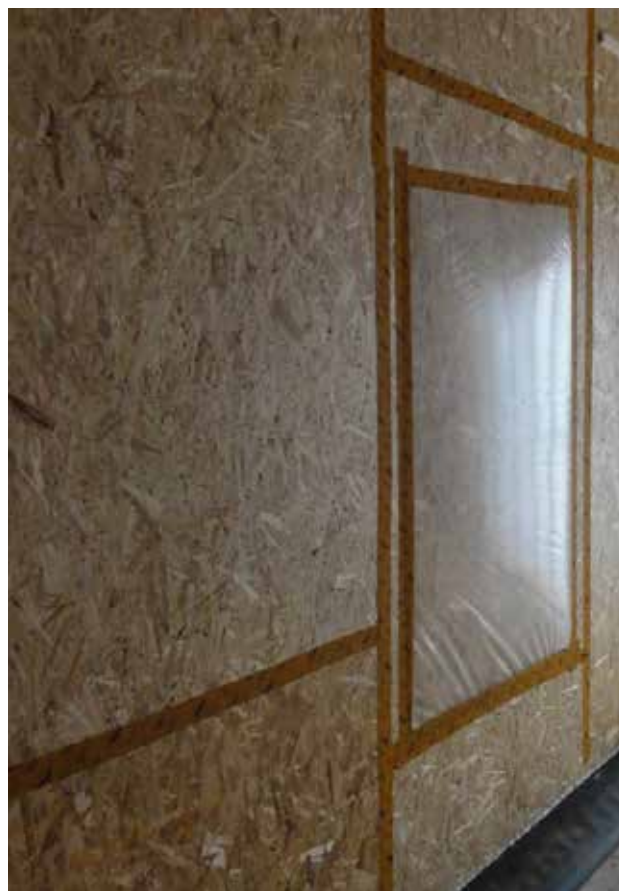
Figur 6.3 – Eksempel på tæthedsmåling af en OSB-plade.
