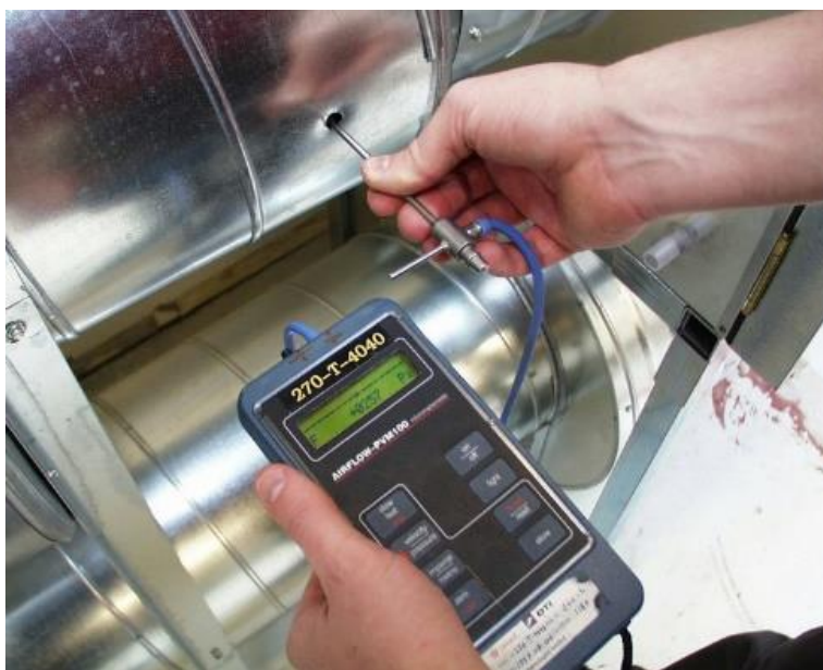
Figur 7.18 Måling af tryk i kanal
