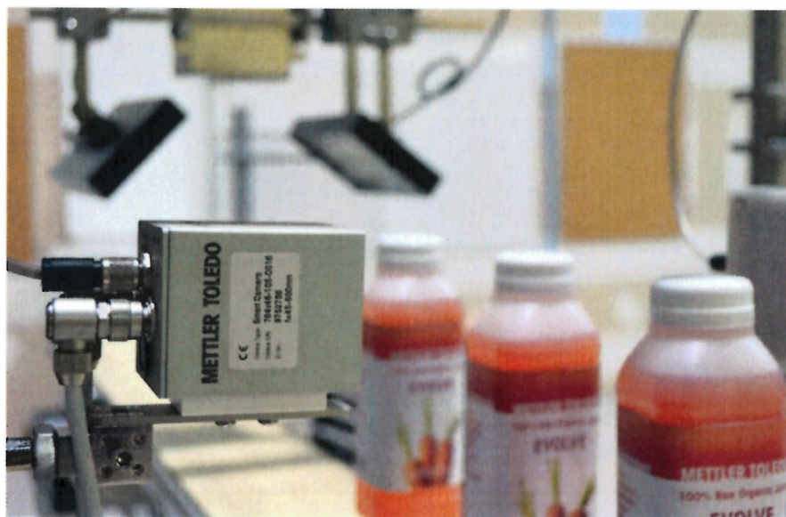
Et komplet visionsystem fra Mettler-Toledo tjekker mærkningen på en gulerodssauce.
