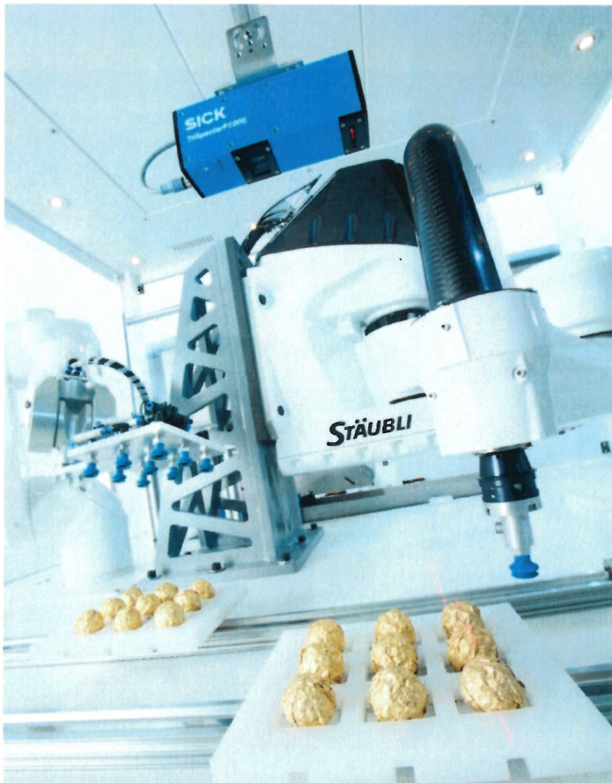
Et visionsystem med komponenter fra Sick A/S kvalitetssikrer og plukker (pick & place) et velkendt chokoladeprodukt, nemlig Ferrero Rocher. Der er tale om 3D Machine Vision, og det anvendte kamera er af typen TriSensor 1000.
