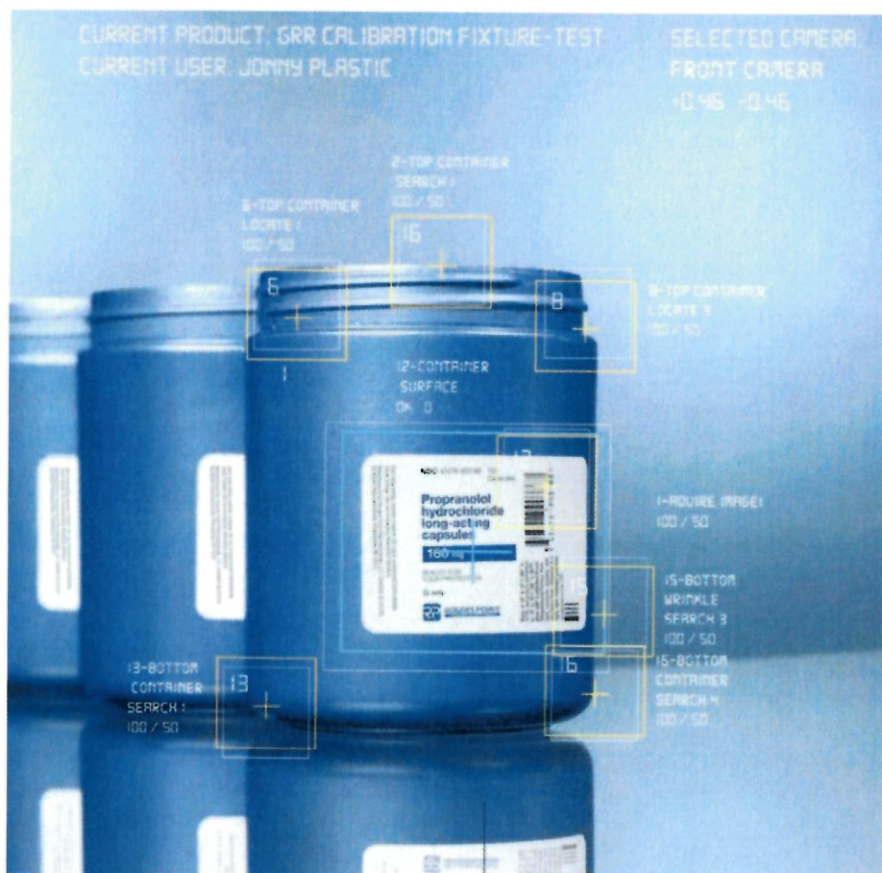
Med automatiseret visuel inspektion bliver selv de mindste detaljer på emballagen lynhurtigt kontrolleret.
