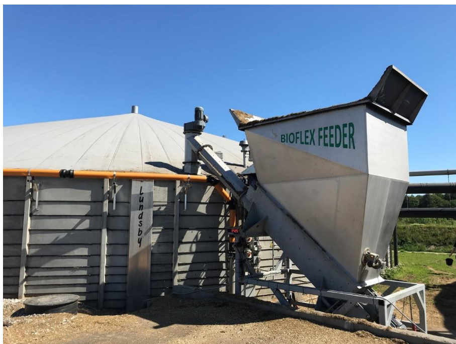
Bioflex Feeder til indfødning af finsnippet biomasse såsom majsensilage, solsikkeaffald, DBG m.m. i efterlager 1. Der installeres snart et tilsvarende indfødningssystem i selve reaktoren.
