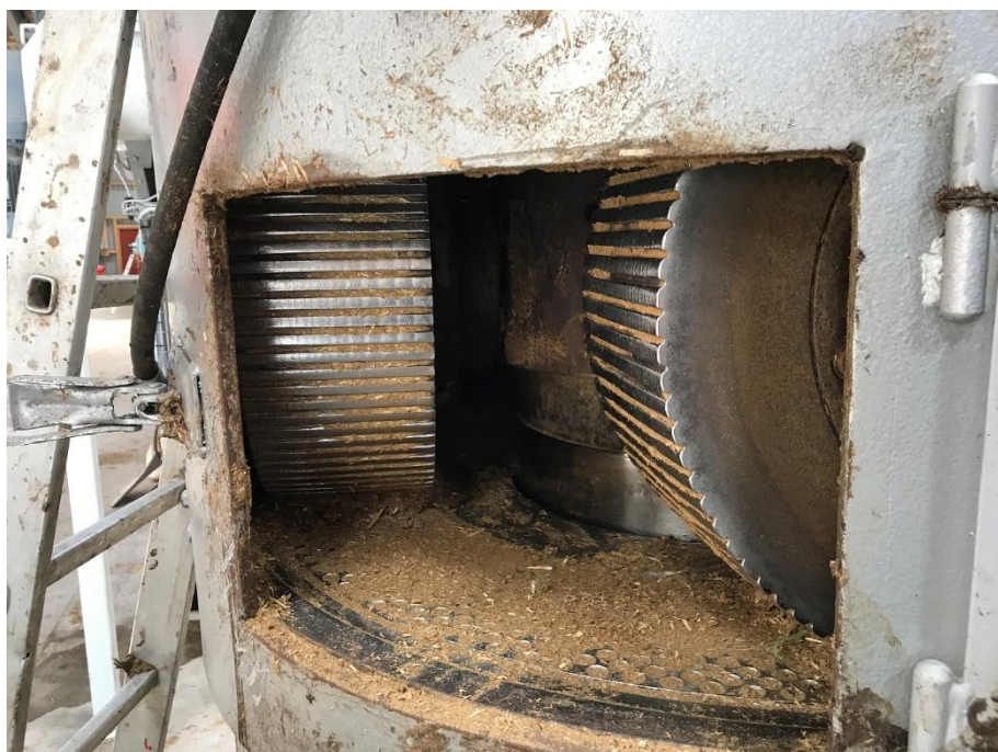
Ruller og matrice i Kahl-mølle/pillepresse.
