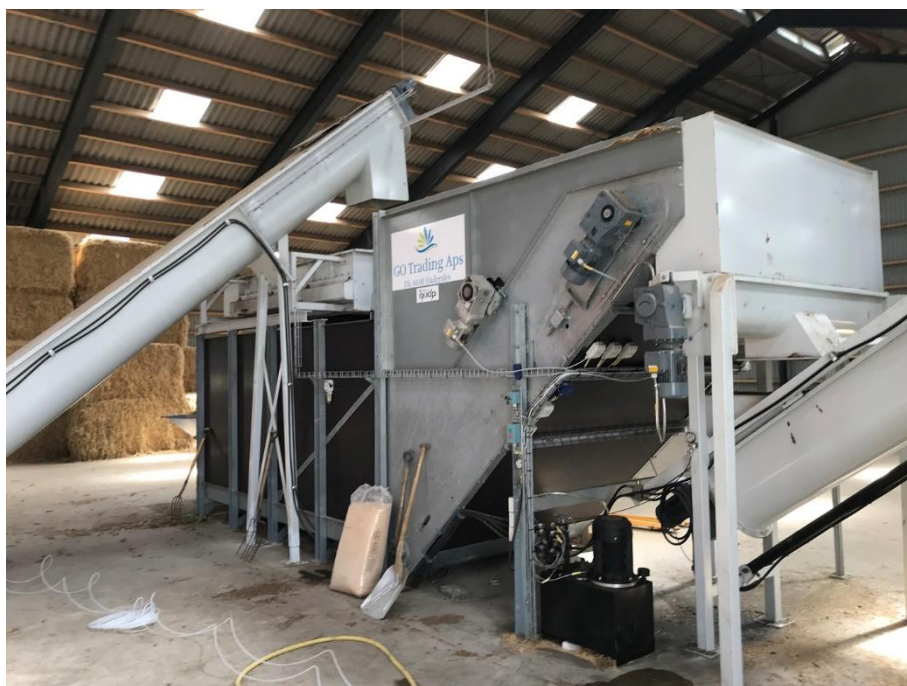
Buffertank til våd halm med stensortering vha. stjernesold og walking-floor til videre indføding til pillepresse.
