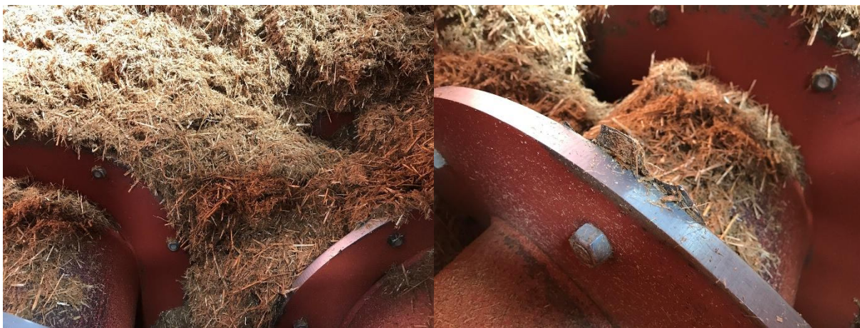
De to snegle med skær i bunden af Seko-foderblande vogn til neddeling af våd halm.
