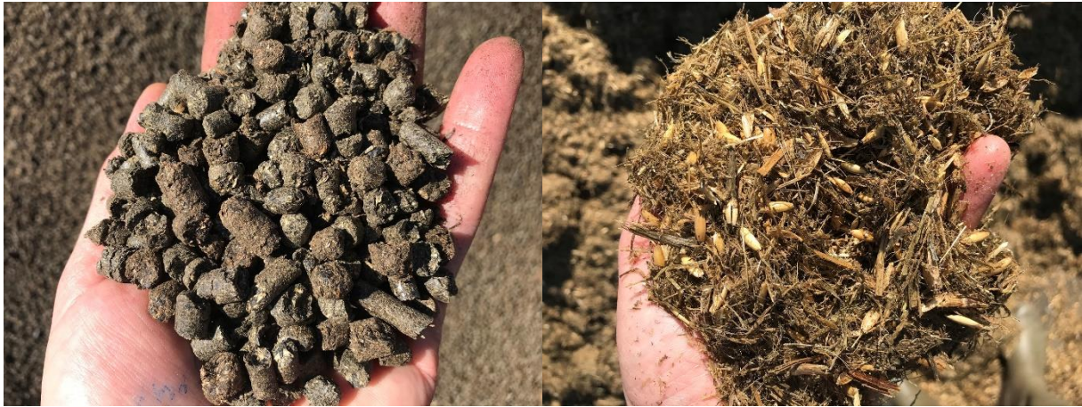
Til venstre solsikkeaffald, til højre DBG med bl.a. havreskaller. Begge dele indføres vha. Bioflex Feeder i efterlager 1.
