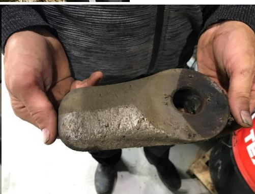
BHS-Sonthofen biogrinder/hammermølle samt slagler før og efter slitage.
