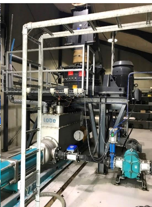
T.v. Lobe mixerenhed til opblanding af gylle fra reaktor 1 og 2 med fast biomasse fra biogrinder. T.h. Opstilling med biogrinder øverst og mixerenhed nederst.
