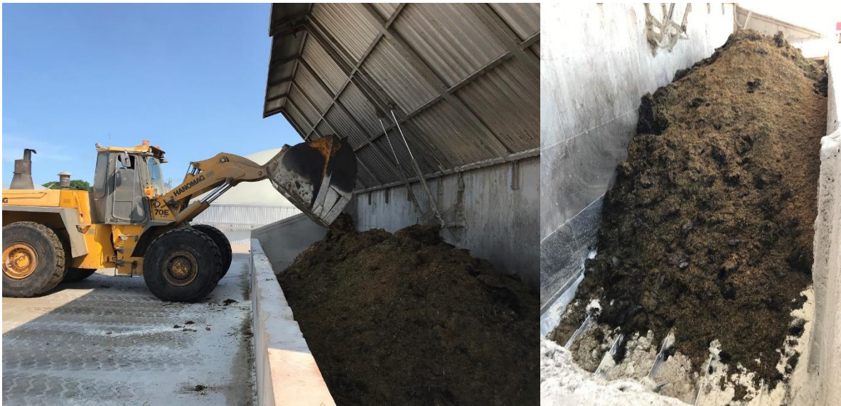
Opfyldning af påslag med walking floor til fast biomasse.
