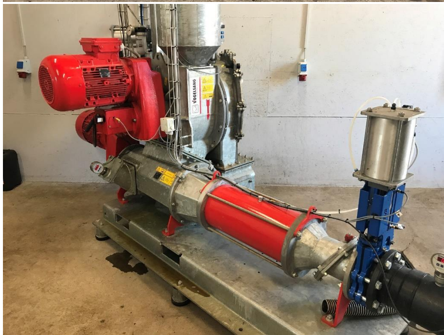
Øverst BvL premixer og nederst Vogelsang-mixer til indføddning af fast biomasse.
