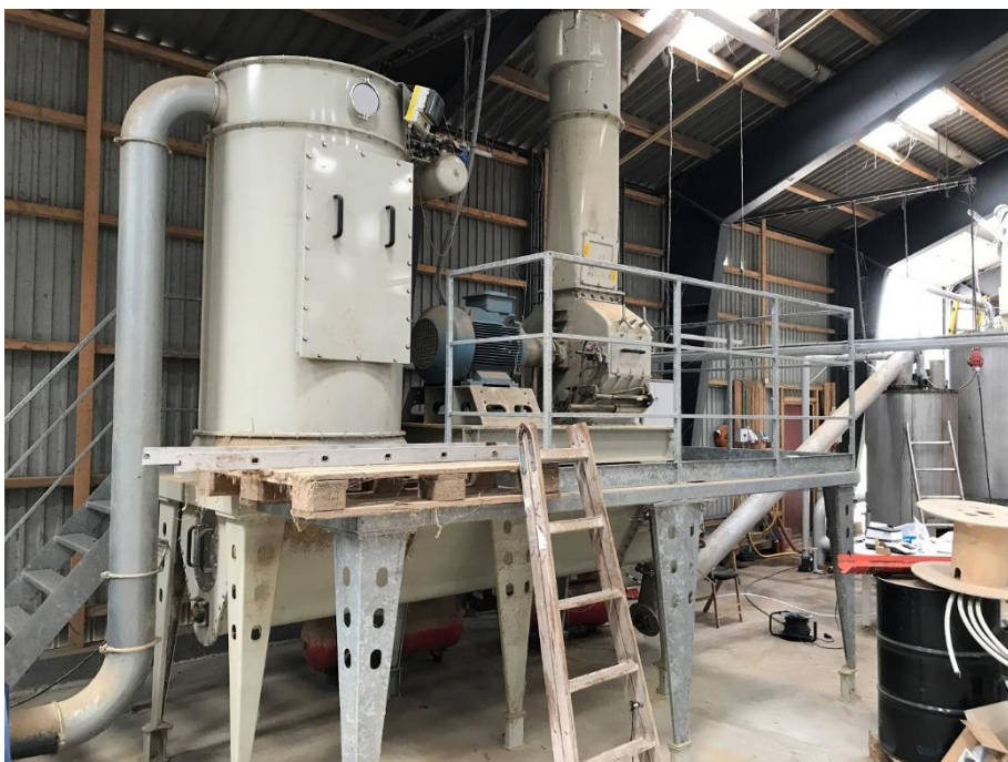
Hamtermølle med 5 mm sold til neddeling af tør halm før opblanding med afgasset gylle i tank til højre i billedet.
