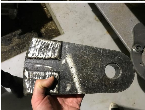
BHS-Sonthofen biogrinder/hammermølle samt slagler før og efter slitage.
