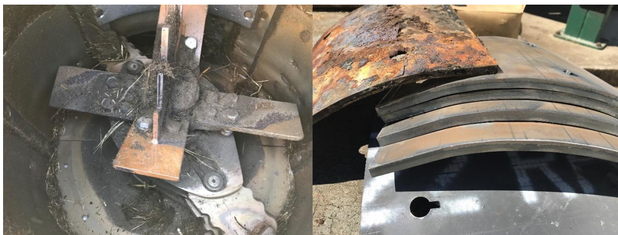
Til venstre ses de 4 slagler i Bomatech hammermølle og bagerst udtaget. Til højre ses et brugt modskær samt 4 nye modskær til montering i hammermøllen.
