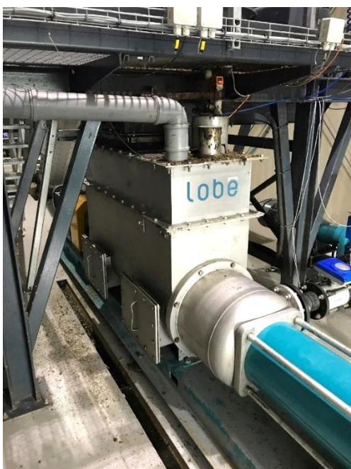
T.v. Lobe mixerenhed til opblanding af gylle fra reaktor 1 og 2 med fast biomasse fra biogrinder. T.h. Opstilling med biogrinder øverst og mixerenhed nederst.
