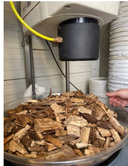
Figur 3. Eksempel på udstyr til offline målinger (her: NIR). Prøver udtages i en separat proces og placeres derefter i prøvebakken.
