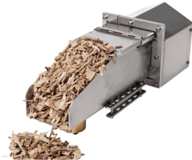
Figur 2. Eksempel på udstyr til at-line måling (her en fugttransducer). Udstyret er designet til at tage prøver i en faldende strøm med jævne mellemrum.
