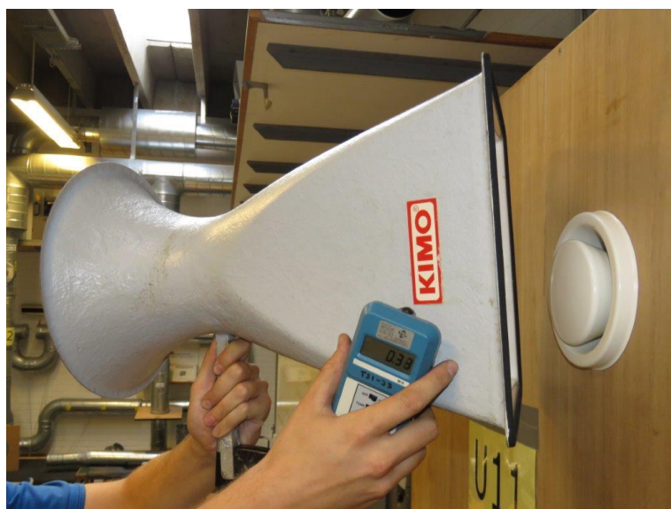
Figur 6.11. Måling med håndholdt måletragt
