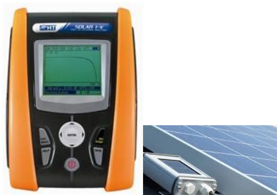
Figur 6.21 Apparat til måling af strøm- spændingskarakteristik kaldet IV-curve tracer. En glat kurve som vist er tegn på en sund modulstreng. Til højre er vist referencecelle til måling af solintensitet. Sensoren skal anbringes i samme plan som solcellerne
