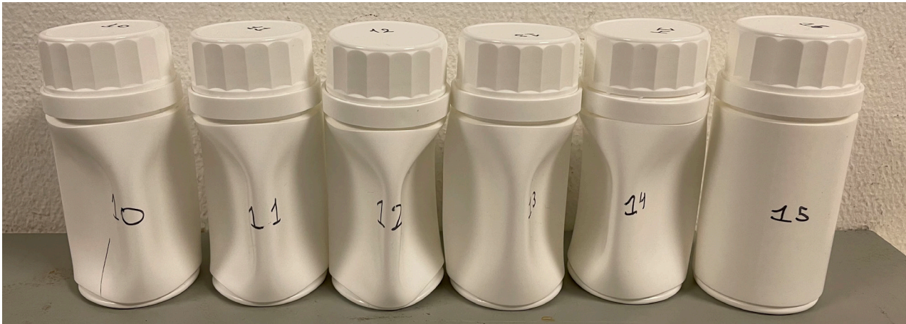
Figur 2, Gastransmissionshastigheden for CO 2 gennem plast er højere end for nitrogen og ilt, som er i luften. Derfor diffunderer CO 2 hurtigere ud fra plastbeholderen end luften fra atmosfæren fylden den, og derved dannes et undertryk i beholderen. På billedet ses beholdere 10-14, der er kollapsede pga. undertryk, samt kontrolbeholder 15 med luft.
