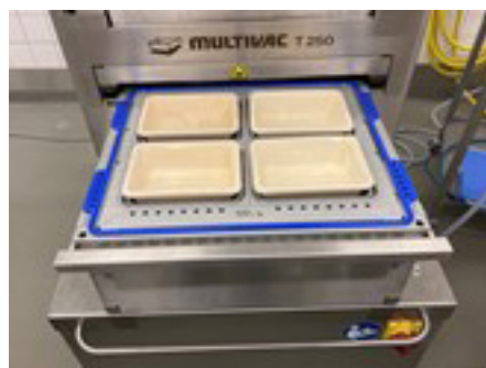
Figur 5: Cellulosebakker forsejlet i en MAP-bakkeforsegler.
