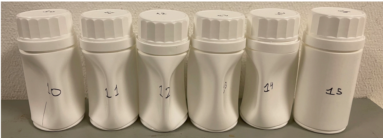
Figur 2, Gastransmissionshastigheden for CO 2 gennem plast er højere end for nitrogen og ilt, som er i luften. Derfor diffunderer CO 2 hurtigere ud fra plastbeholderen end luften fra atmosfæren fylden den, og derved dannes et undertryk i beholderen. På billedet ses beholdere 10-14, der er kollapsede pga. undertryk, samt kontrolbeholder 15 med luft.
