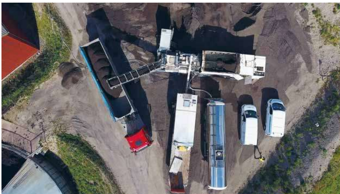
Fremstilling af BSM på et mobilt KMA-anlæg og pålæsning på lastbil med transportbånd.
