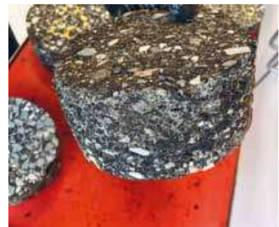
Borekerner af BSM, tilsavet i 6 cm tykke prøvelegemer til laboratorietests.
