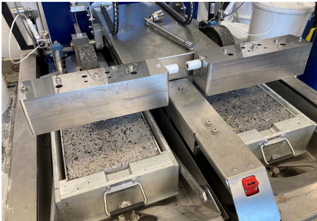
Fig. 5.7.2: Billedet viser de to 10 cm tykke testplade af BSM med slaggegrus efter afsluttet sporkøringstest med 10.000 dobbeltpassager ved 45 °C: Trods 10 cm pladetykkelse kan sporet i midten af pladerne knap anes med det blotte øje.
