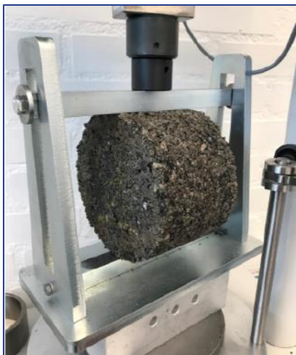
Fig. 5.5.1: Spaltetrækstyrkebestemmelse for evaluering af vandfølsomhed
