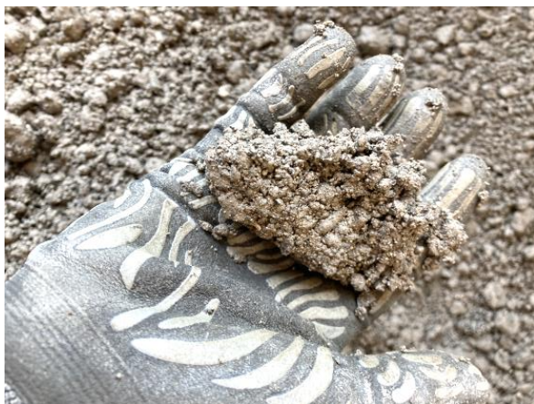
Fig. 5.2.2 viser, at nyproduceret BSM med slaggegrus har den ønskede sammenhængskraft når man trykker en prøve sammen i handsken.
