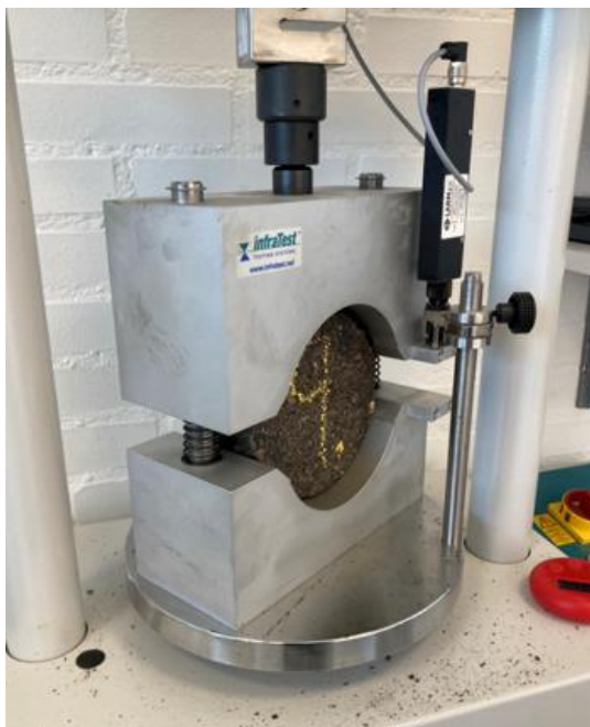
Fig. 5.7.1: Marshall-trykstyrke-prøvning af Ø150 mm BSM prøvelegeme ved 25°C.
