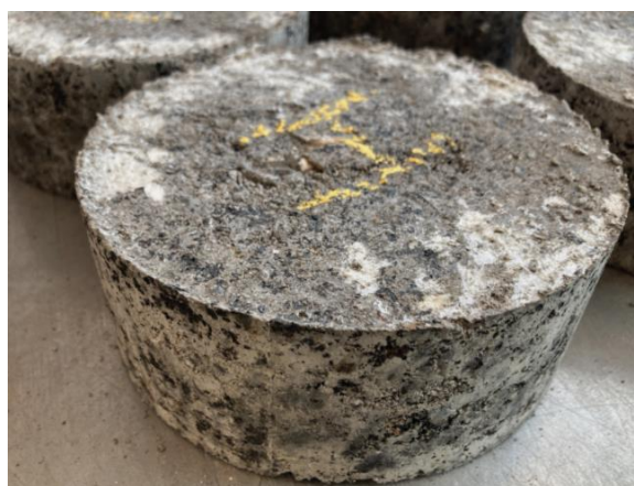
Fig. 5.2.3: Vibrationsindstampet BSM-prøvelegeme baseret på AFATEK slaggegrus. Pæn, tæt overflade.
