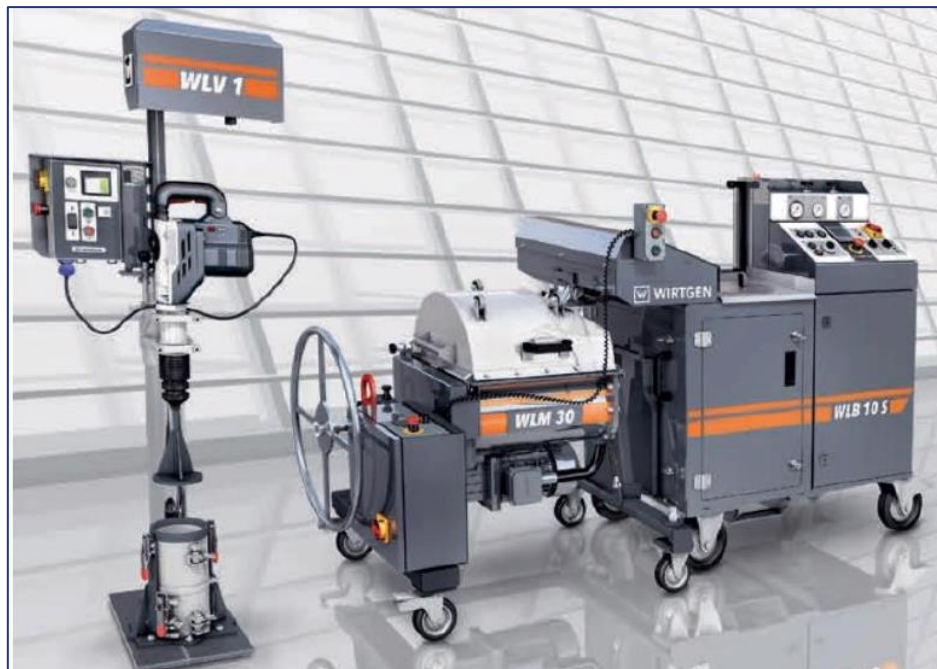
Fig. 5.2.1: Laboratorieudstyr til fremstilling af BSM (Kilde: Wirtgen). Til venstre vibrationsindstamper, i midten BSM-blendmaskine, som på billedet er sammenkoblet med skumbitumen fremstillingsenheden til højre i billedet.
