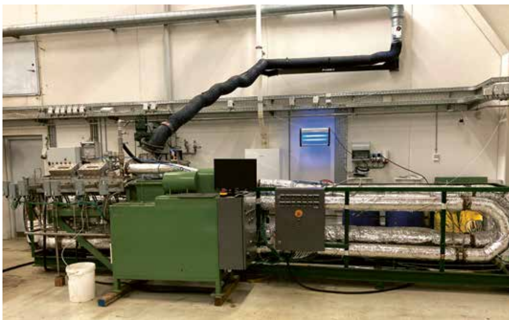
Pilot-anlæg til hydrothermal carbonisation på Aarhus Universitet.
