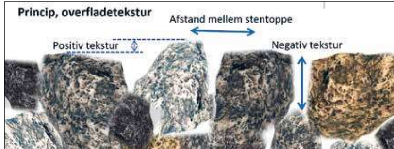
Figur 2: Princip for belægningsoptimering: For at opnå en ideel overfladetekstur skal den positive tekstur (opspring) minimeres. Samtidigt skal afstanden mellem stentoppene i overfladen minimeres. Endelig skal den negative teksturdybde (overfladehulrum) optimeres – men uden at skabe gennemgående hulrum der tillader vandgenemsivning.
