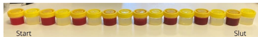
Figur 2. Foto af permeat- og retentatfraktioner gennem filtreringsprocessen.
