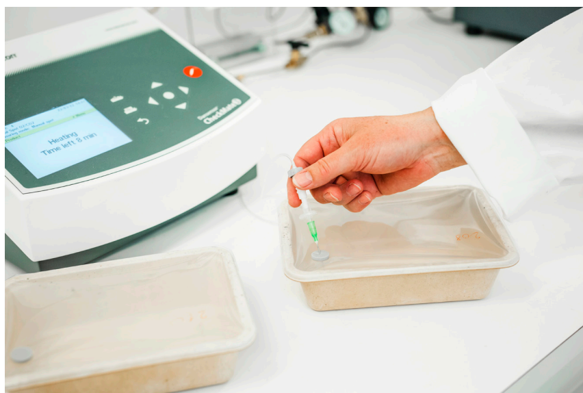
Fig 3: Karakterisering af iltkoncentration i forseglede celluloseemballager med en CheckMate II.
