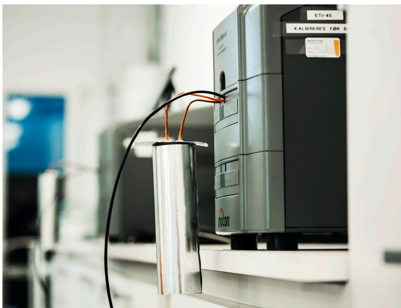
Figur 1: OX-TRAN og PERMATRAN maskiner fra Ametek-MOCON til barrierekarakterisering.
