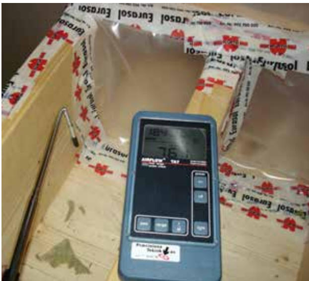
Figur 8.11 – Der måles 7,6 m/s, hvilket kun er muligt ved uhindret strømning. Går strømningen igennem isolering dæmpes den afhængigt af isoleringens densitet og kompression.
