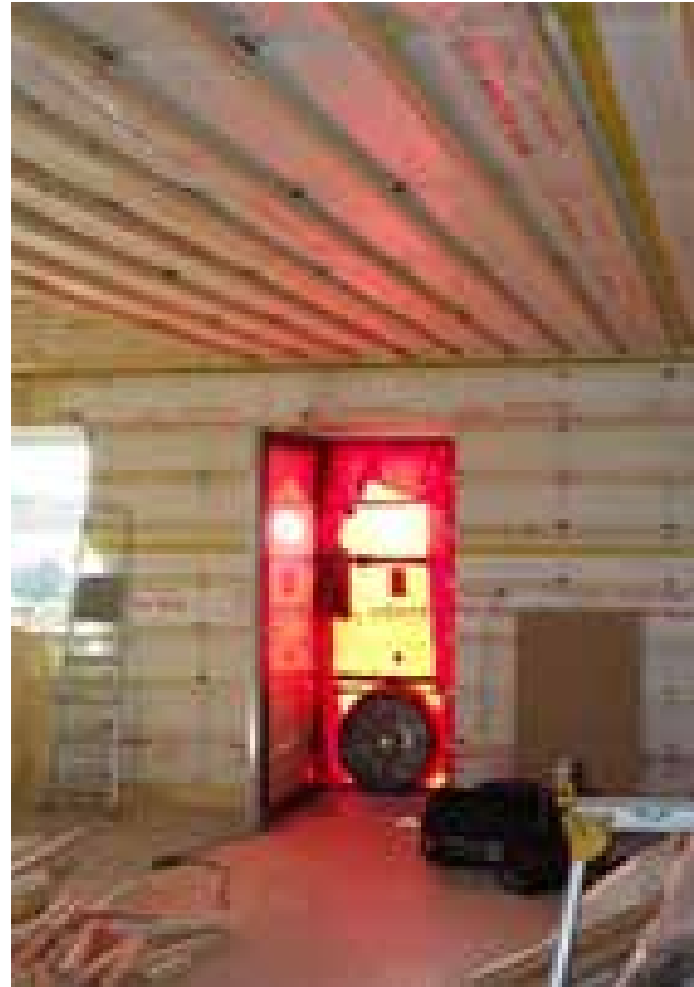
Figur 8.1 – Eksempel på en igangværende trykprøvning af synlig dampspærre er effektivt når der bygges med skrappe tæthedskrav.
