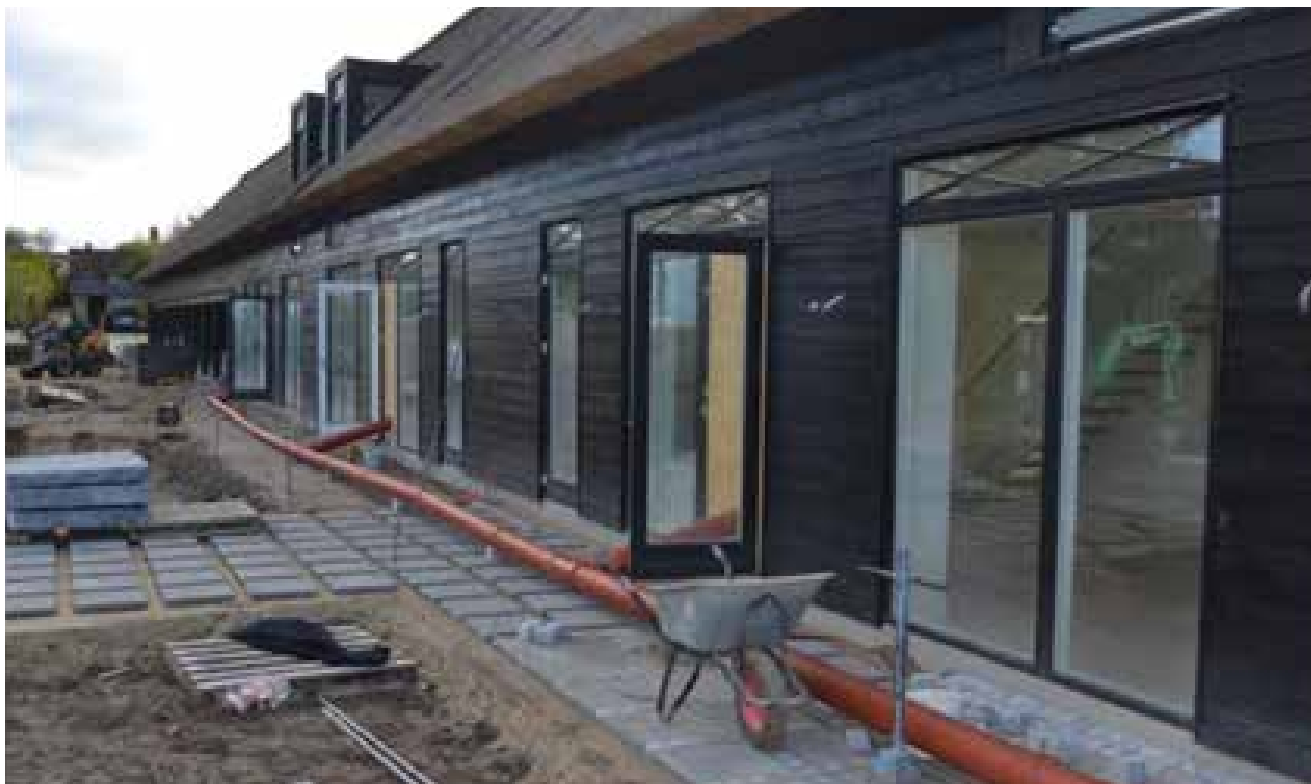
Figur 6.6 – Eksempel hvor samtlige lejligheder testes med én blæser, med luftsammenhængen gennem kloakrør. Dette vurderes ikke som en valid trykprøvning da der ikke opnås ensartet trykforhold i hver lejlighed.
