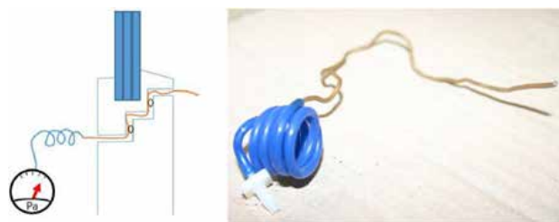
Figur 5.5 – Kapillarrør med slangetilslutning til måling af trykforskellen gennem en vinduespakning/forsegling, [14].
