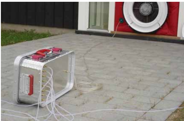
Figur 3.1 – Eksempel på trykudligningsboks. Her med 8 slanger fordelt ud på grunden. Det vurderes dog, at 2-4 slanger vil være rigeligt.
