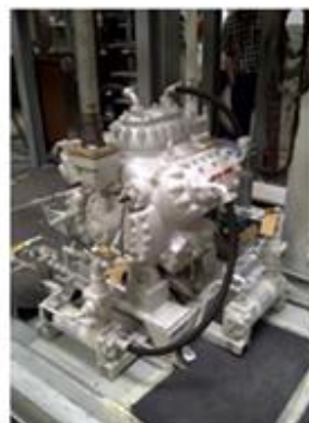
Figur 6.24 Prototypewarmepumpe fra IBK (NL) til produktion af damp ved ca. 115 °C baseret på R600 (butan) installeret ved papirfabrik [23].
