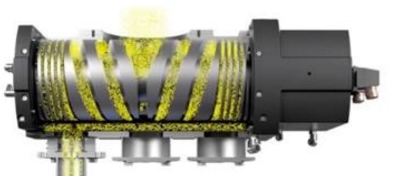
Figur 6.31 Spindle-kompressor fra Hamburg Vakuu/KRAL, der har temperaturløft fra 110 °C til 230 °C med en kapacitet på 130 kW.
