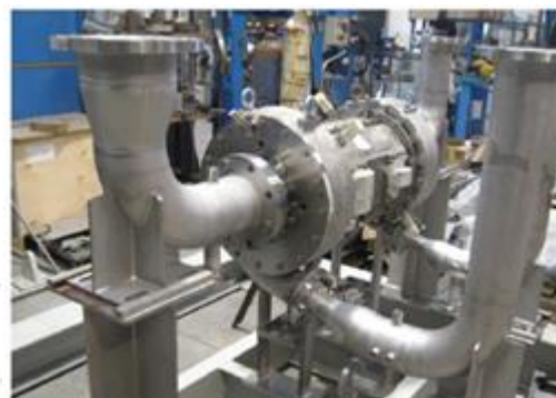
Figur 6.27 Totrinsdampkompressor baseret på JCI's turbochiller unit med magnetiske lejer. Billede fra testopstilling [25].
